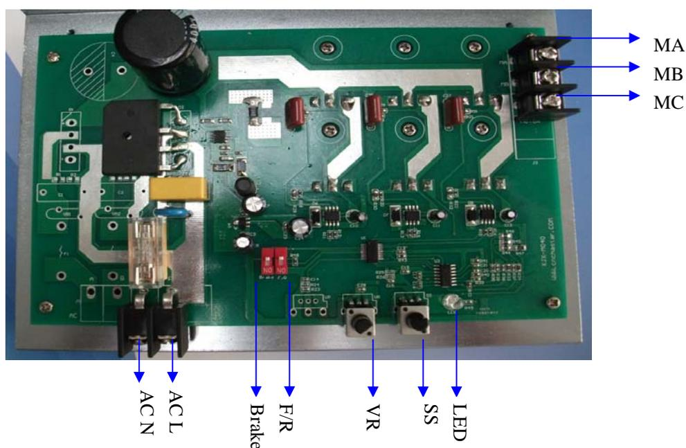
**注: 控制器中各电位器, 往左旋转为 5V, 往右旋转为 GND**
