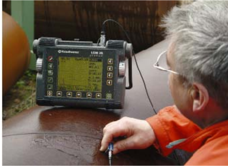
对焊缝进行检测
