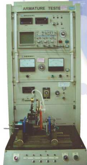
電樞自動檢驗設備 Armature Tester
