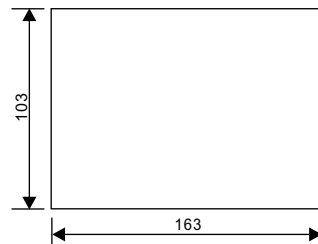
屏式安装开孔尺寸
