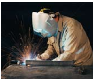
应用CO 2 气体保护和0.045的实芯焊丝焊接时的传统的恒压短路过渡
