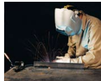
应用CO 2 气体保护和0.045的实芯焊丝焊接时的STT（表面张力过渡），注意它减少了飞溅和烟雾
