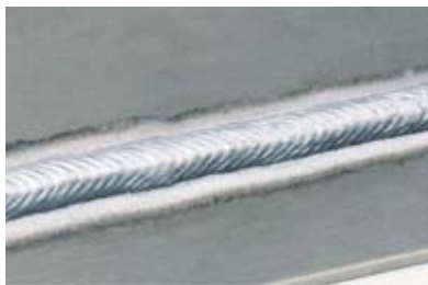
Pulse-on-pulse应用在3mm铝焊接中
