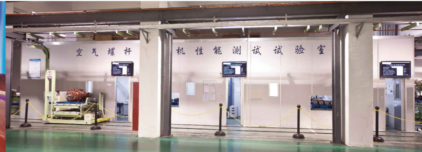
空气螺杆压缩机性能测试实验室
