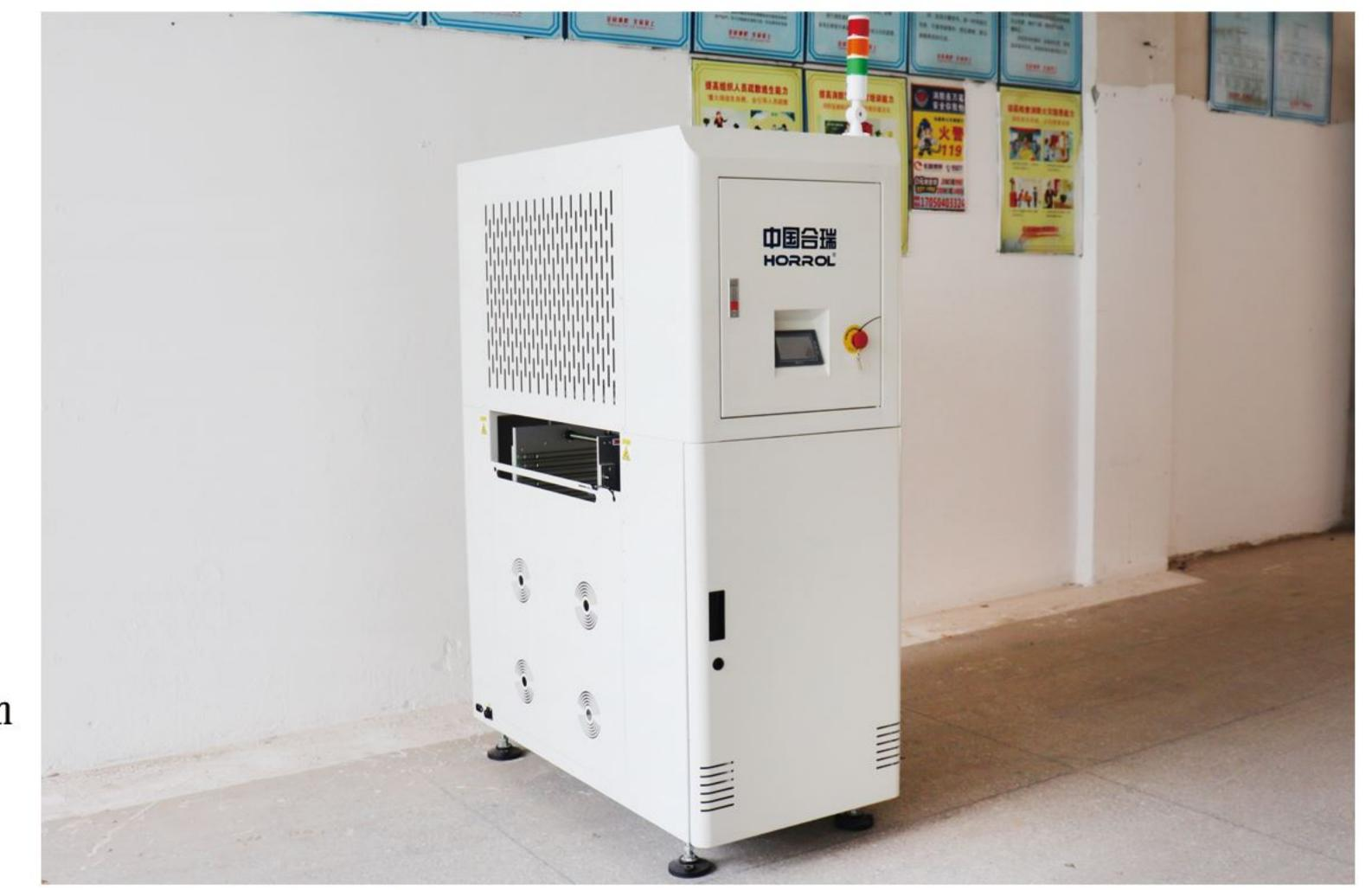
$/2200 \times 1120 \times 1200 \text{mm}$ 控制模块: 西门子PLC工控 上框时间:约6秒 料箱更换时间:约20秒 电源及负荷: 220v/0.3kw **气压及流量:** 4<sup>~</sup>6bar, ≤10升/分钟 传送高度: 920±20毫米 传送方向: 左到右或右到左 电路板厚度: ≥0.4mm 步距选择: 1-4 (10毫米步距) 感应器品牌: 欧姆龙 步进及运输电机: 台湾中大 料框尺寸: 355x320x563/460x400x563/535x460x563/535x530 PCB板传输方向: 左到右或右到左 x563mm
