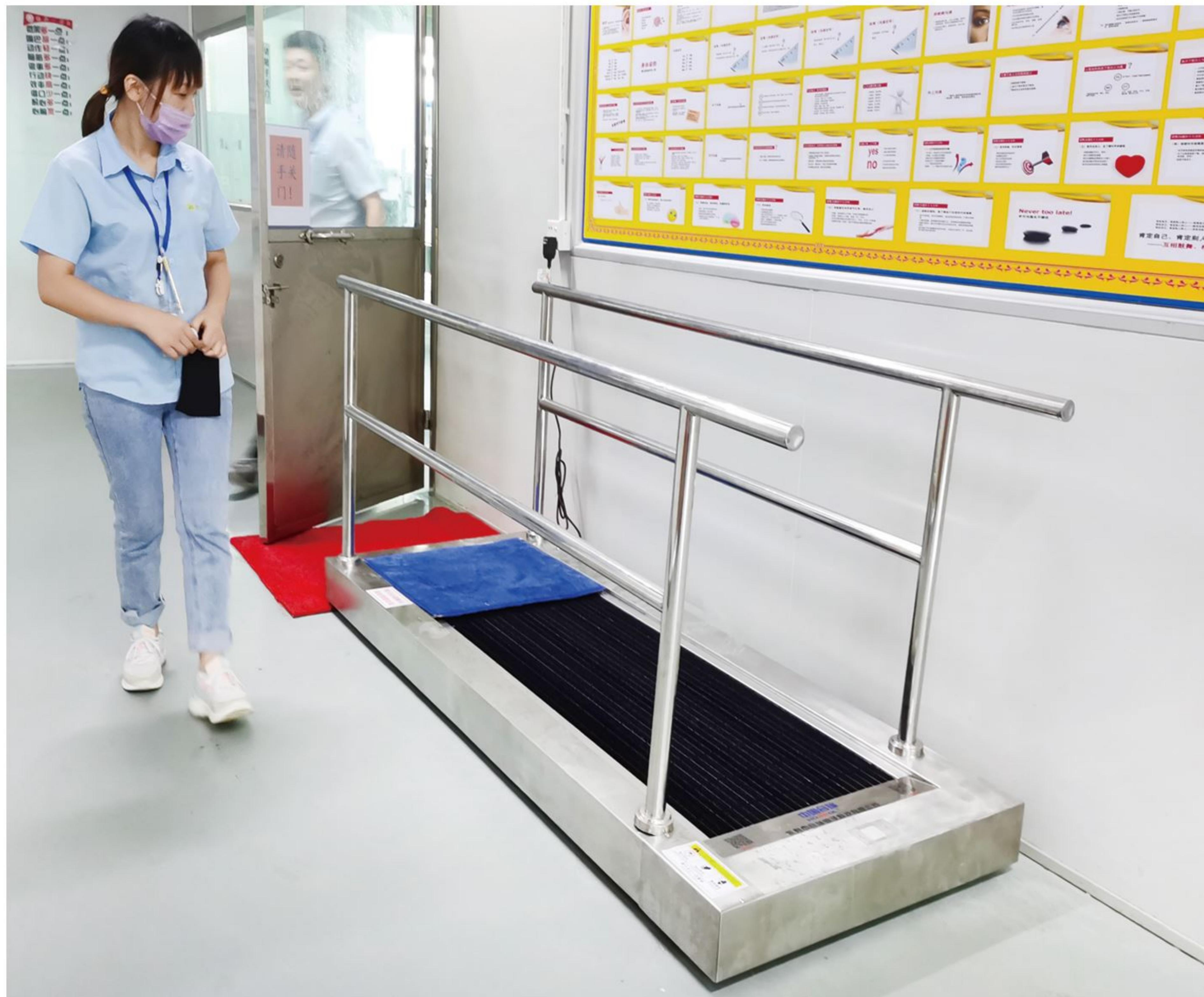
鞋底清洗机作为一种入口鞋底清洁设备，旨在解决由鞋底带进室内的污尘问题。通过鞋底清洗机自动感应启动，浸湿的履带毛刷旋转摩擦鞋底，从而清理掉鞋底污尘，将污尘阻挡在入口处，减少室内地面清洁工作量，为保持室内环境洁净度树立一道屏障。
