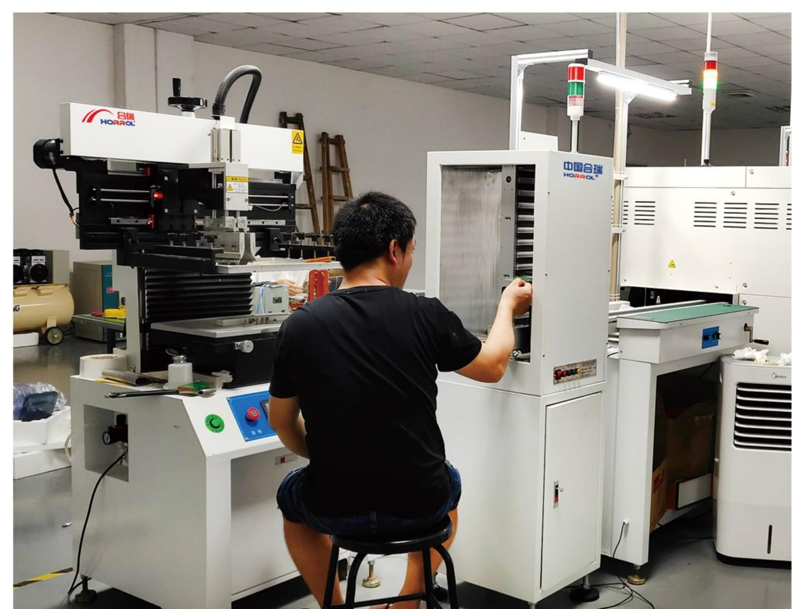
东莞市合瑞电子科技有限公司是一家专业电子生产设备制造商，根据市场需求，开发了多功能微型送板机，此款设备采用传统稳定的机械按键，微型上板机占地面积小适用于所有场所所有smt的上板任务，自动多方位感应器，迷你上板机可事实无延迟自动调平和防卡板功能，只需调平设备对应轨道对接24v短路信号线即可投入生产，迷你送板机搭配半自动锡膏印刷机可高效灵活送板创造更多价值。
