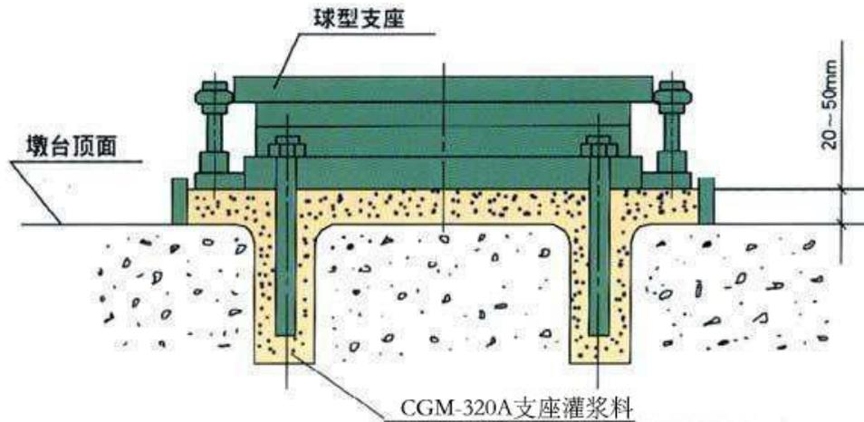
1、将支座安装于梁底，安装时应使支座的对称中线与梁体底板的对称中线重合，偏差不得大于 0.5mm；逐次拧紧支座螺栓，各个螺栓的拧紧程度应基本一致；螺栓紧固完成后，支座与梁体支座板之间不得有间隙。
