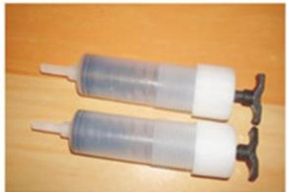
此工具具有加压功能，使用时可根据实际需要调整压力，可以保证 0.1MPa~1MPa 的压力。
