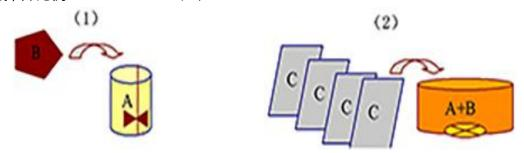
舀取: 舀取水性环氧树脂、水性环氧固化剂要使用各自的勺子,切记勿交叉使用,否则导致原材料报废;
