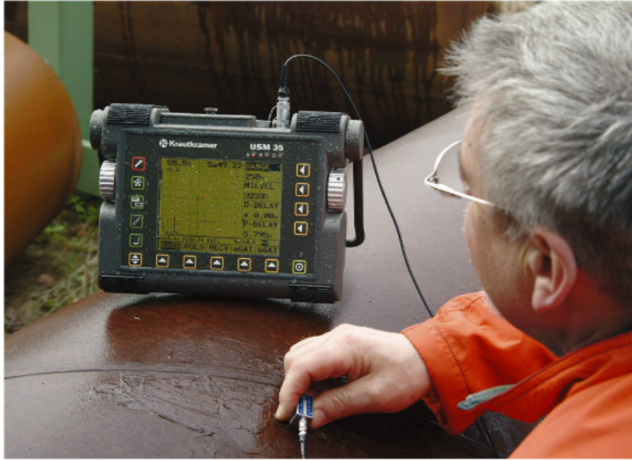
对焊缝进行检测
