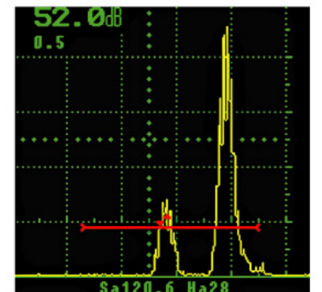
JFlank：测量闸门第一个回波的声程和波幅。
