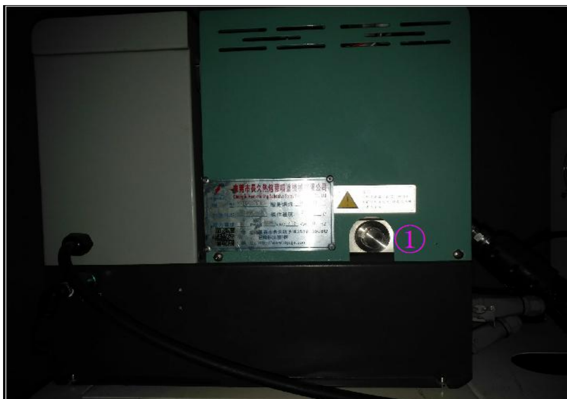
如图：①、胶机滤网，逆时针旋转扭出，定期清理（正常工作 3~6 个月清洗一次）， 【注意：拆卸时胶机气压一定处于关闭状态】
