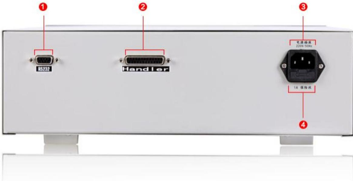
图 3-3 仪器后面板示意图
