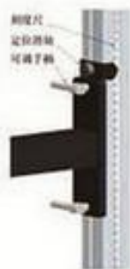
传感器垂直位置调节结构 Vertical adjuster
