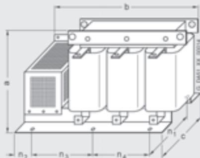
适用于 GX 外形尺寸的正弦滤波器
