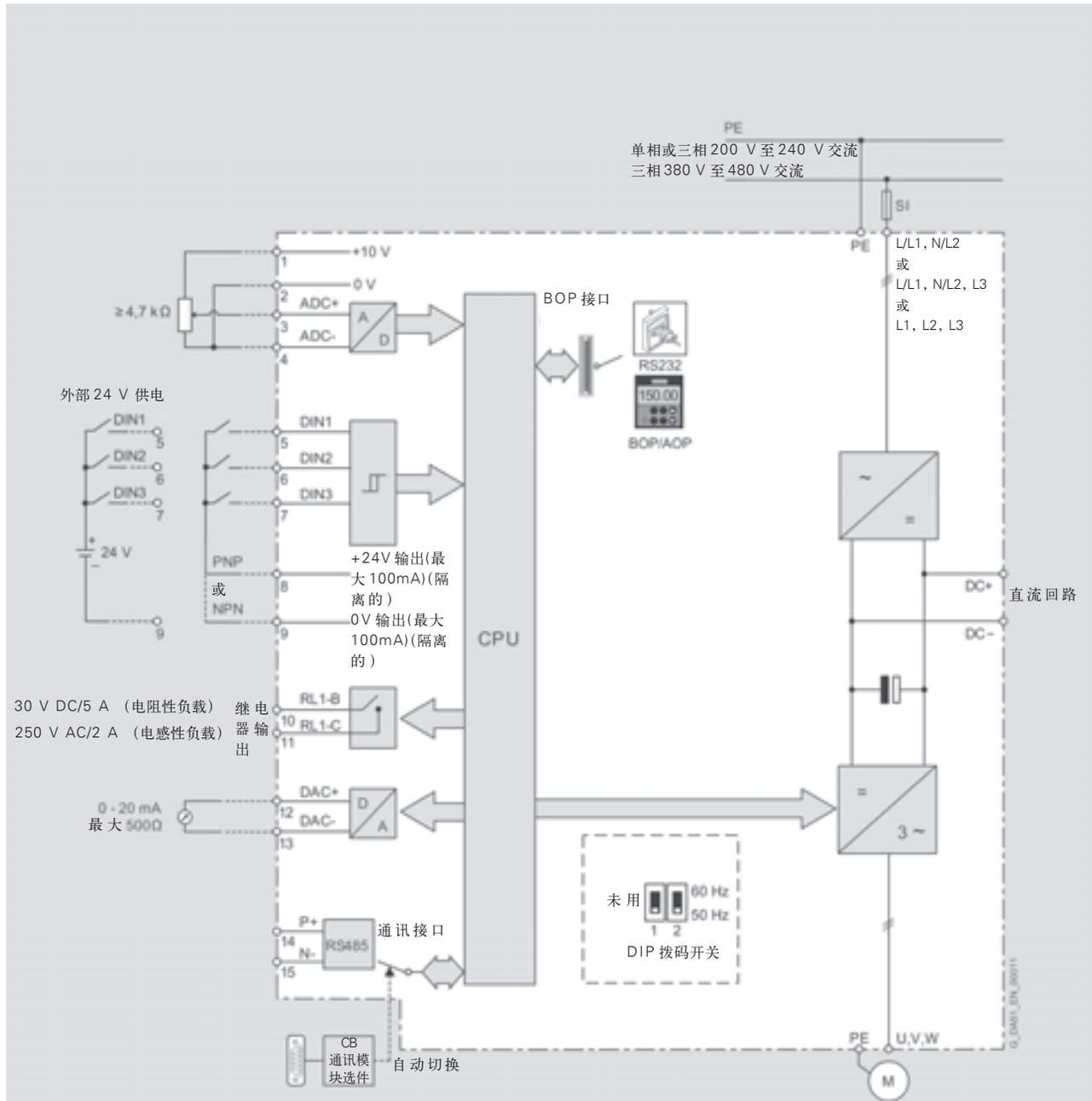
模拟输入可以作为第 4 个附加的输入，其接线如下图所示。
