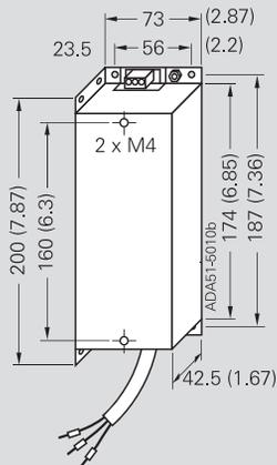
适合 A 型箱体尺寸的滤波器
