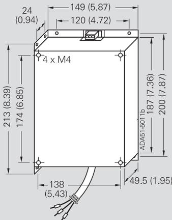
适合 B 型箱体尺寸的滤波器
