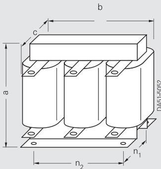
适合 F 型箱体尺寸的进线电抗器
