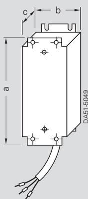
适合 A 型箱体尺寸的输出电抗器
