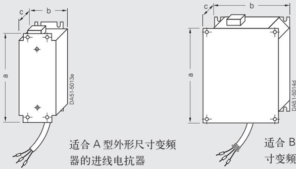
适合 A 型外形尺寸变频器的进线电抗器
