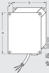
适合 D 型和 E 型外形尺寸变频器的进线电抗器
