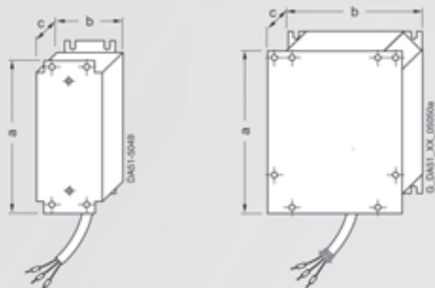
适合 A 型外形尺寸变频器的输出电抗器
