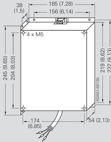
适合 C 型箱体尺寸的滤波器
