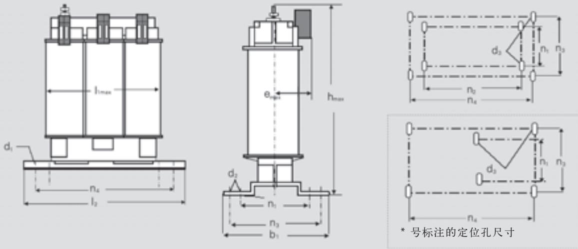
适合 A 型箱体的国产进线电抗器
