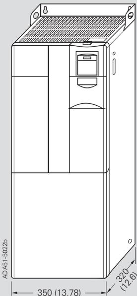
无滤波器的 F 型外形尺寸变频器
