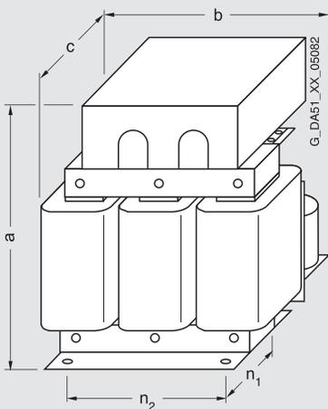
适合 FX 和 GX 箱体尺寸的进线电抗器
