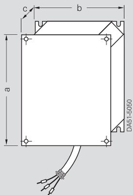
适合 C 型箱体尺寸的输出电抗器
