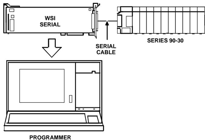
图 10-1 串行接口至 WorkStation 接口板的电缆连接
