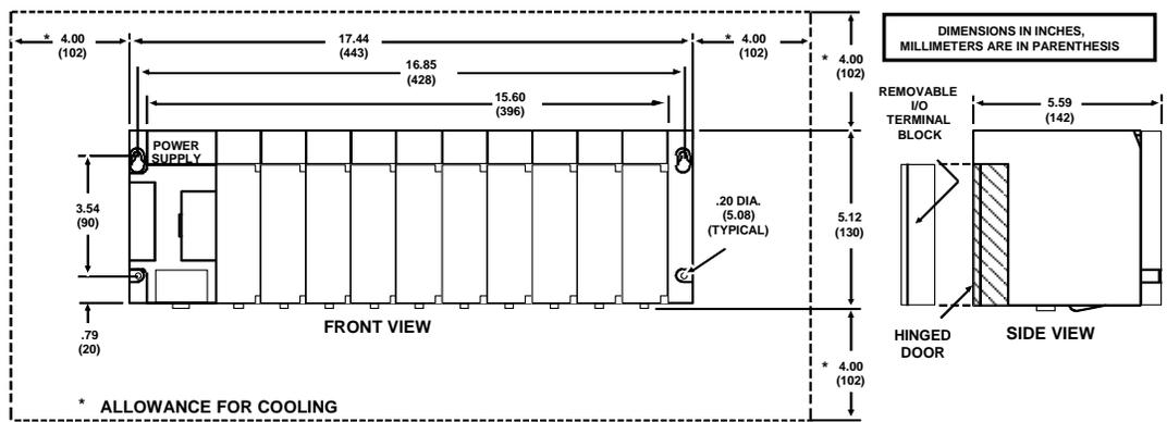
图 3-15. 323 10-槽基板安装尺寸和空间要求
