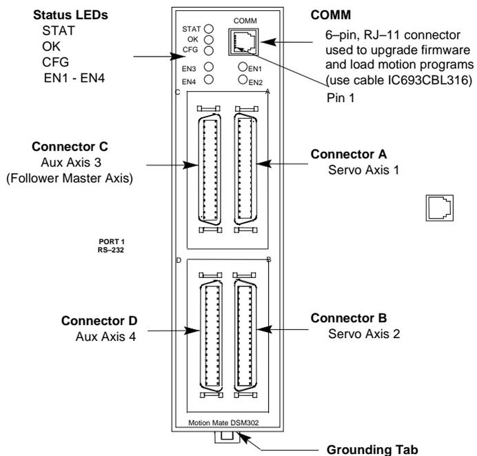
图 8-12. 运动旋转 DSM302 模板
