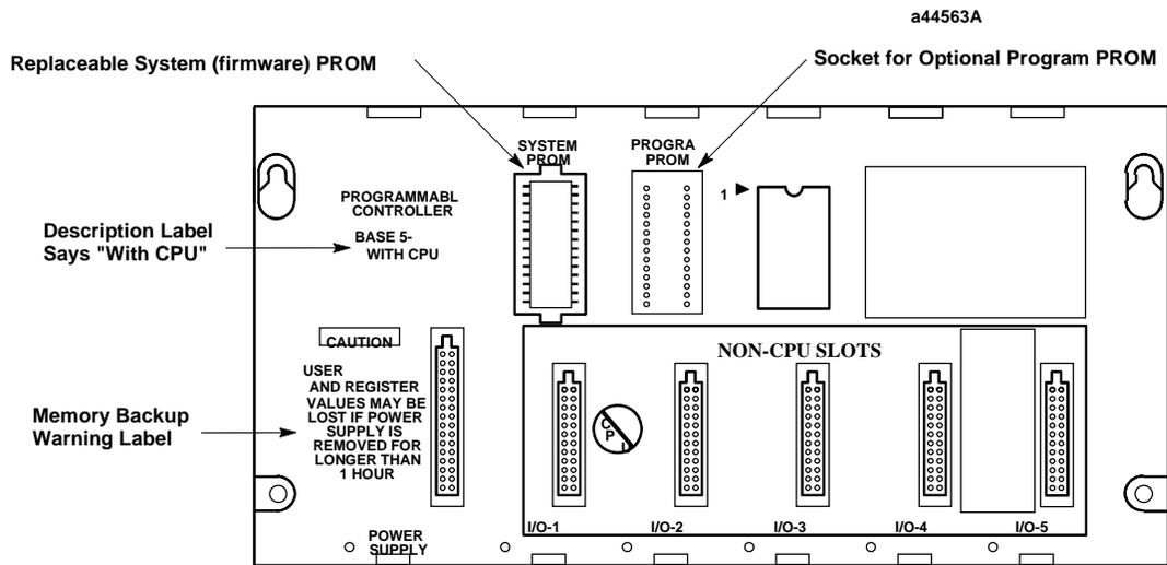
图 5-1 311 和 313(5 槽)嵌入式 CPU 模板基板
