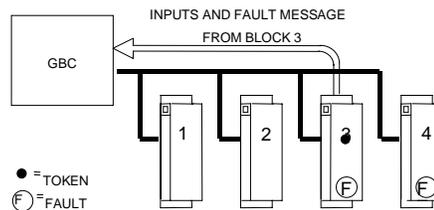
在一个总线扫描周期内只能有一个诊断信息被发送. 如果在某个扫描期间一个故障信息已经被发送 (通过另外的一个设备), 设备会保存自己的诊断信息直到下一个总线扫描. 例如, 如果正扫描到设备 3 的时候设备 3 和 4 同时出现了错误, 那么如果此时另外的信息还没有被发送, 那么设备 3 的诊断信息将被发送. 设备 4 必须等至少一个或更多的扫描才能发送它的诊断信息.
