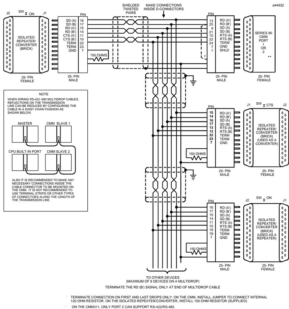
图 C-9 电缆 D;RS-422 双绞线
