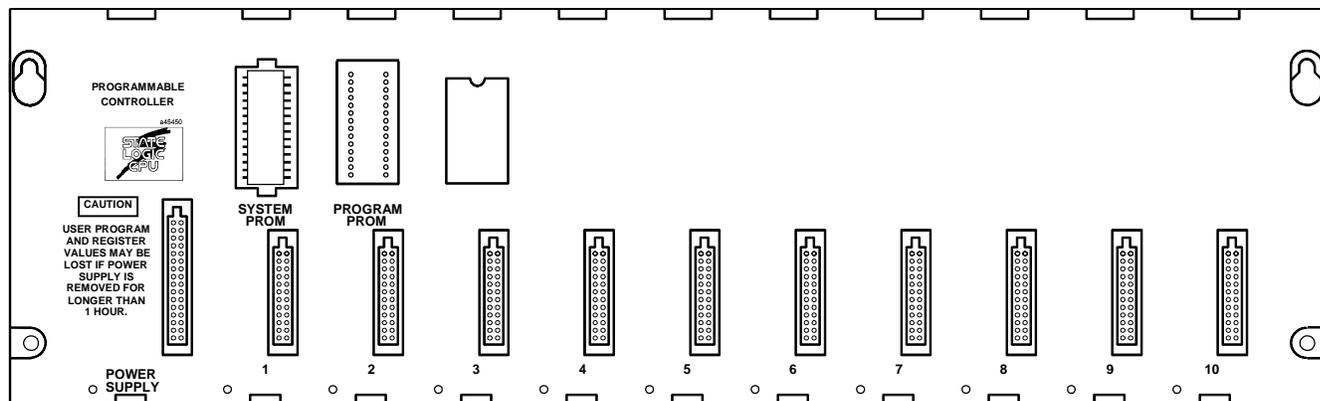
图 9-6. 模块 CSE323 10-槽嵌入式 CPU 底板
