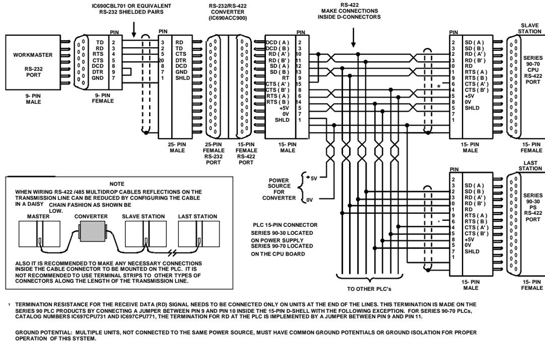
图 A-1。 Workmaster/系列 90 PLC 多站连接
