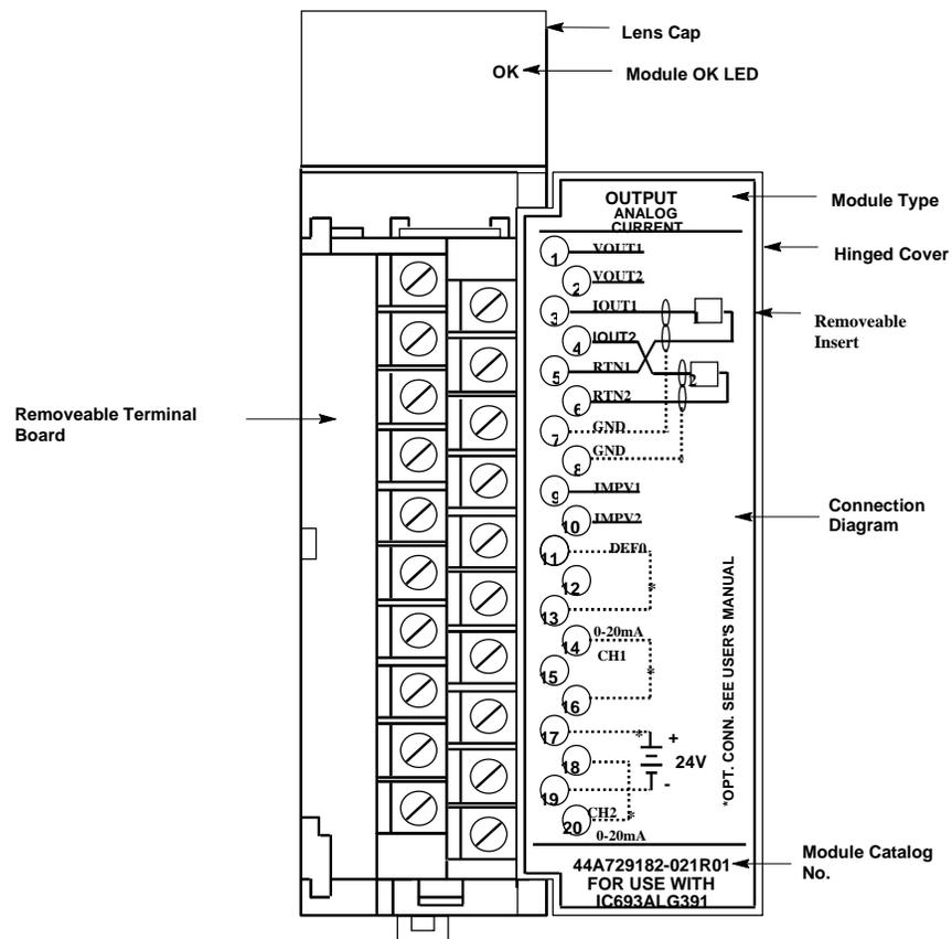
图 7-5 50 针，系列 90-30 模拟量电流输出型模板示例
