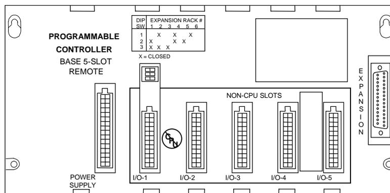
图 3-8. IC693CHS399 5-槽 远程基板
