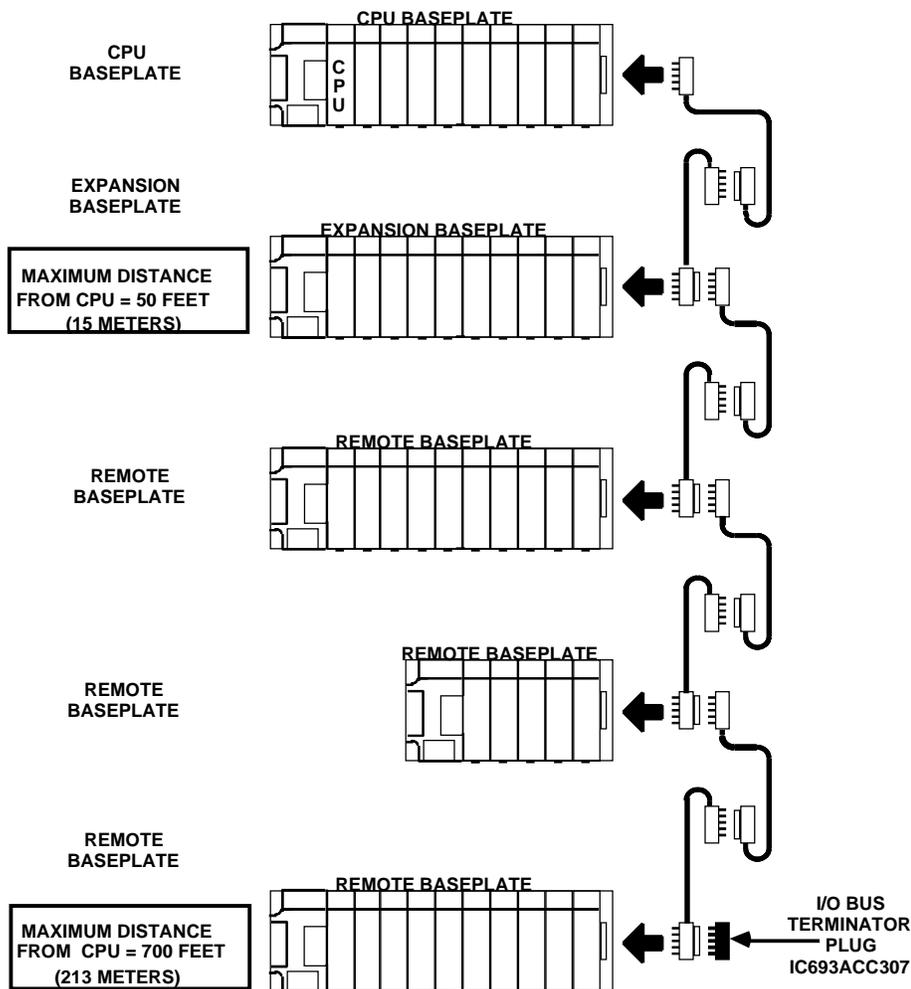
图 1-9 连接有扩展和远程机架的底板
