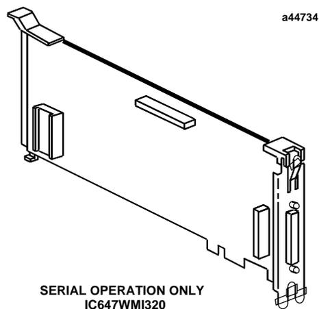
图 11-1 WSI 板用于 Workmaster II 计算机
