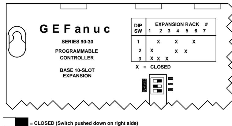
图 3-11. 机架号选择开关(图示选择了机架 2)
