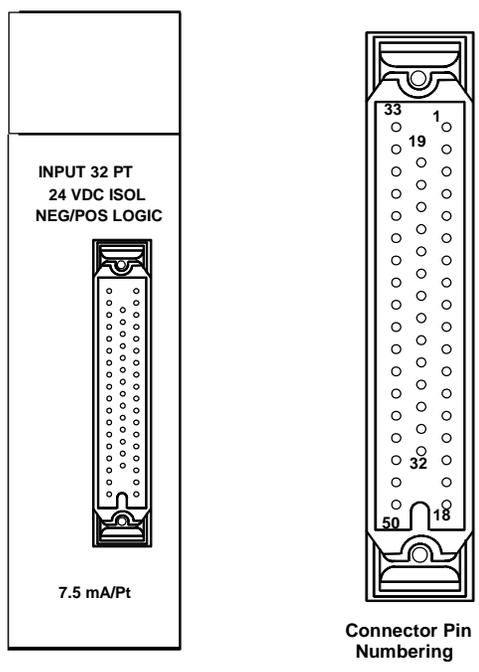
图 7-3 使用单连接器的 I/O 模板 (IC693MDL653) 示例
