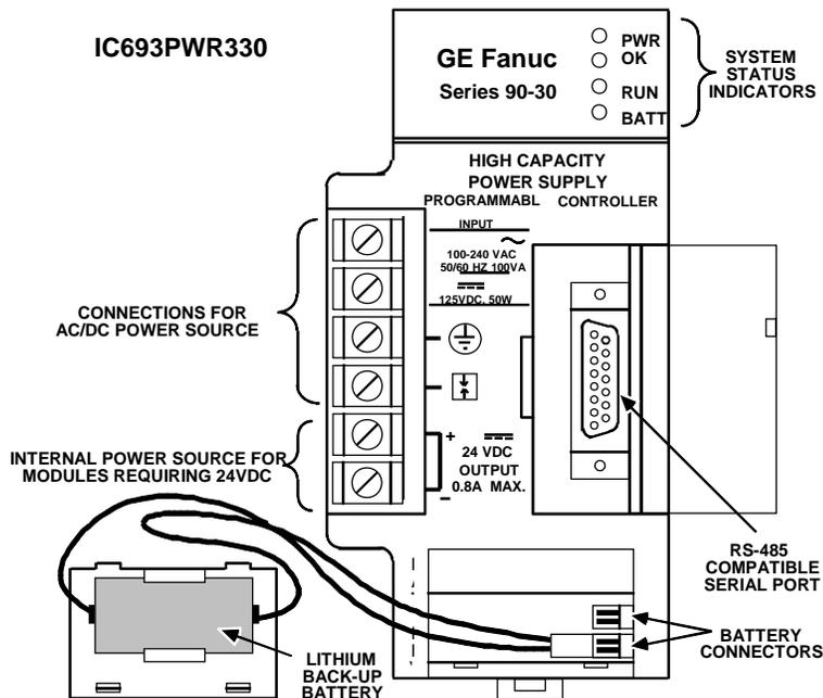
图 4-2. 大容量 AC/DC 输入电源 - IC693PWR330
