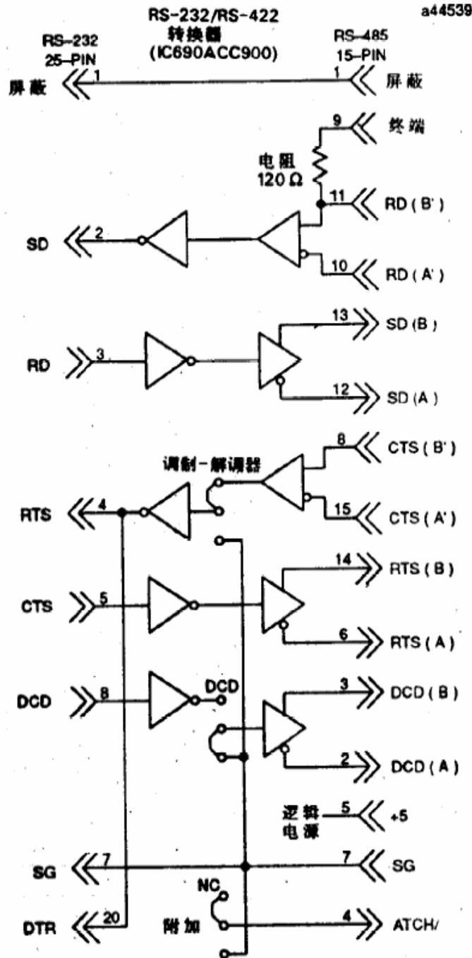
图 B-4 RS-422/RS-485 到 RS-232 转换器的逻辑图
