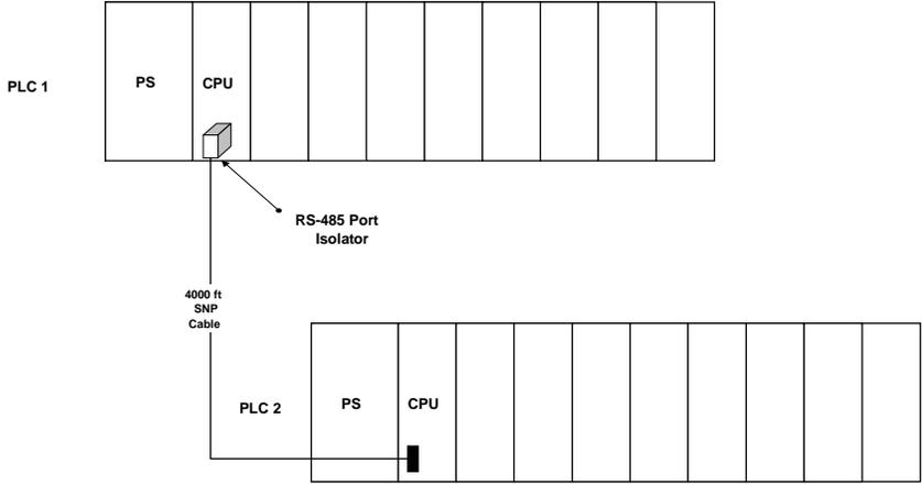
图 E-3。PLC 网络中的 RS-485 隔离装置
