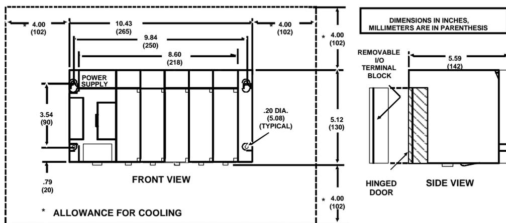
图 3-14. 311 及 313 5-槽基板安装尺寸和空间要求
