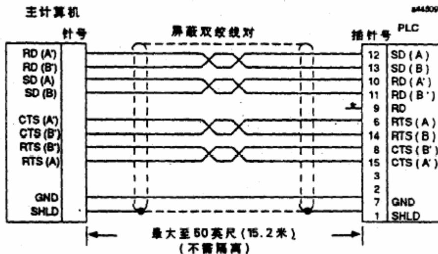
\*只需将用于接收数据(RD)信号的终端电阻连接到处于线路末端的装置上，在 15 针 D 型壳形连接器内的 9 和 10 插针之间连接一跨接线，用此方法可以完成系列 90 PLC 产品的终端，下面是例外。对系列 90-70 的样本号是 IC697CPU731 和 IC697CPU771，其 RD 终端是通过 9 和 11 插针之间连接跨接线来完成
