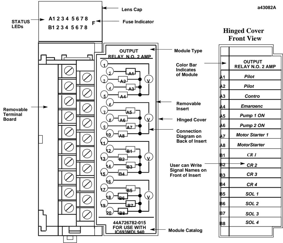
图 7-1 系列 90-30 标准密度数字量输出模板示例
