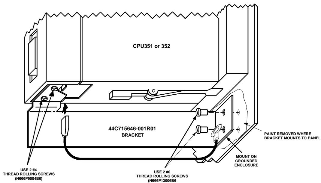
图 2-13 CPU 351 或 352 - 安装屏蔽接地托架和线缆
