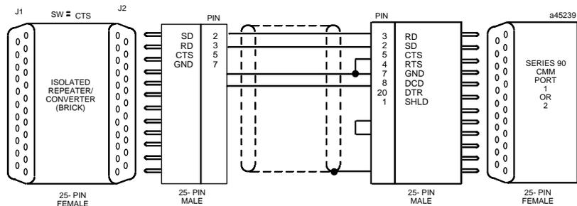
图 C-10 电缆 E;RS-232 转换器至 CMM
