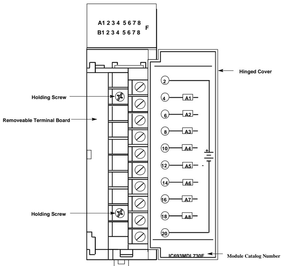
图 2-6. 有固定螺丝的端子板
