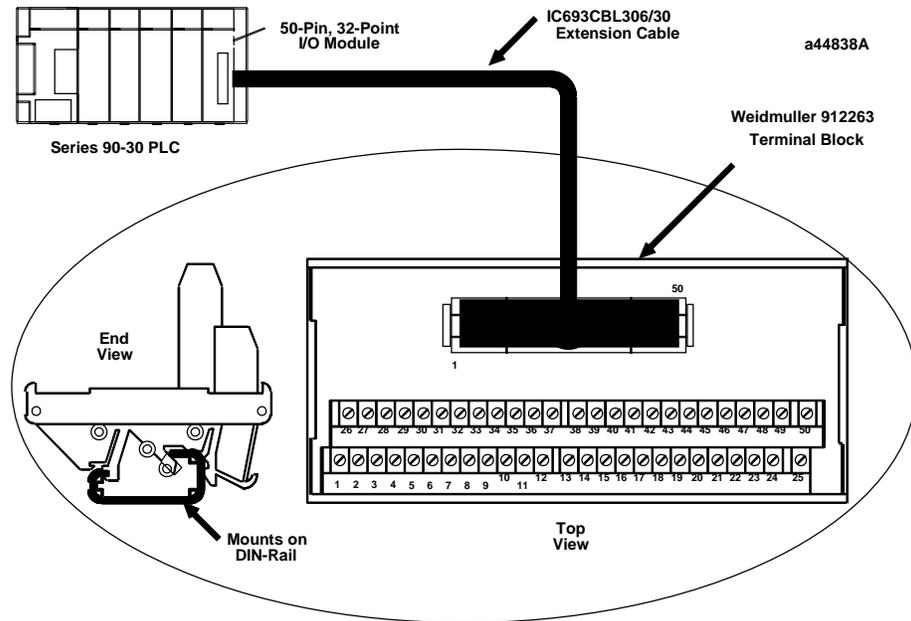
图 7-4 50 针，32 点的 I/O 模板连接方法
