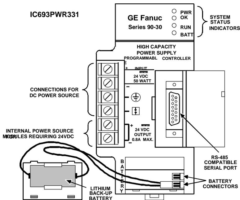
图 4-8. 系列 90-30 24 VDC 输入大容量电源 - IC693PWR331
