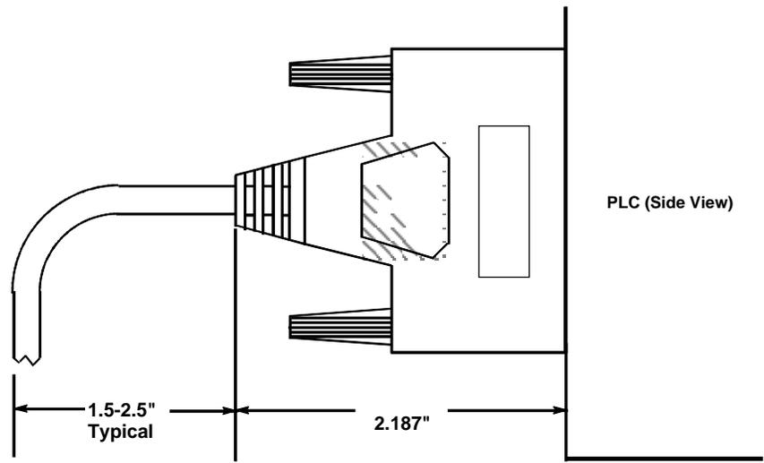
图 10-29 PLC 前面连接器的尺寸长度
