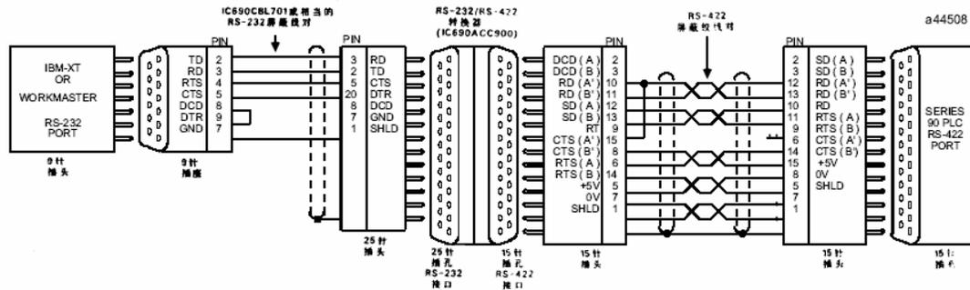
\*用于点对连接的电源电缆仅为 10 英尺(3 米)，超过 10 英尺的转换器电源和用于多点连接的电源必须是外部电源。
