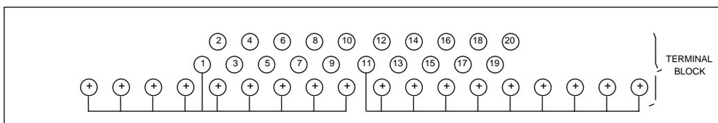
图 H-5. IC693ACC331 TBQC 端子板
