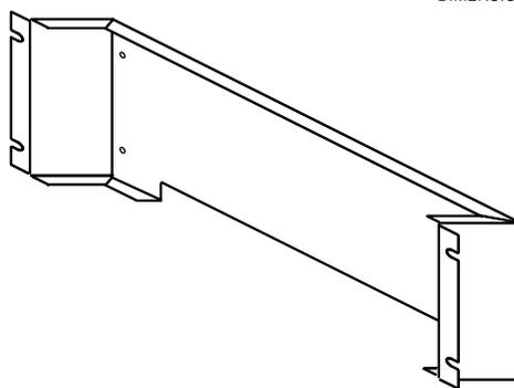
图3-20. IC693ACC313 凹型安装的适配器托架
