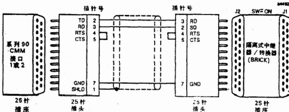
图 C-6 电缆 A;RS-232 CMM 至转换器
