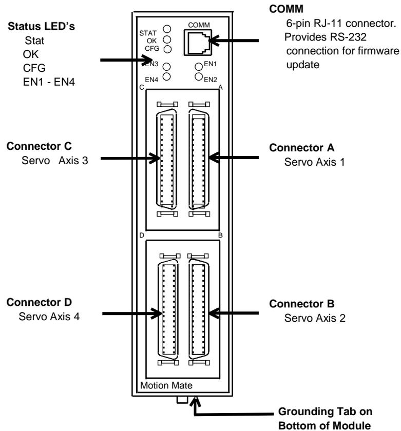
图 8-13. 运动旋转 DSM314 模板
