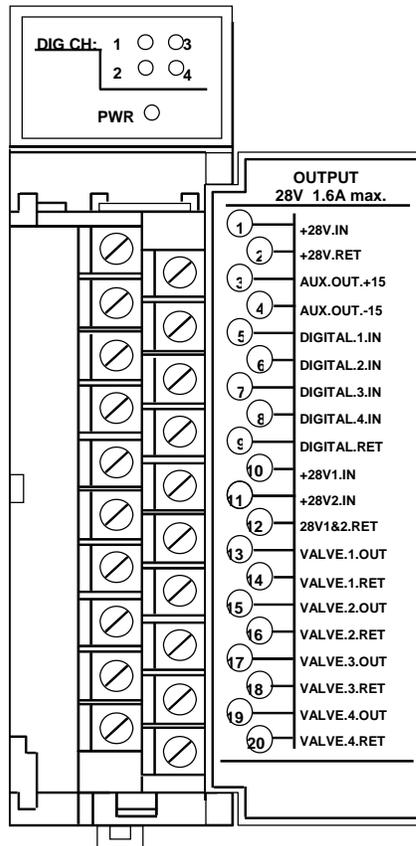
图 7-6 IC693DVM300 数字电子管驱动模板
