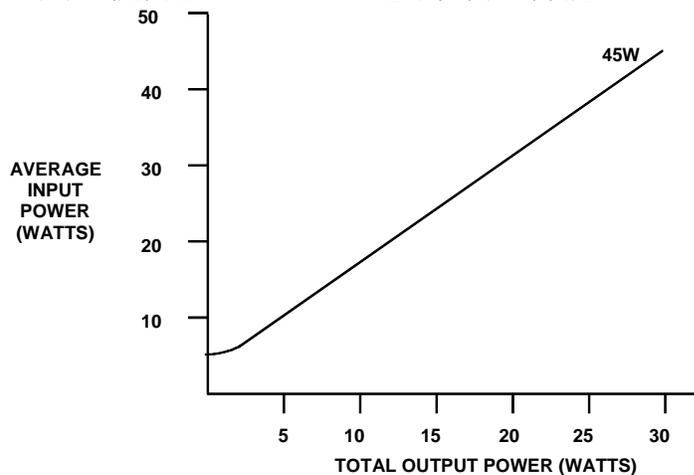
图 4-5. 24/48 VDC 电源的典型效率曲线
