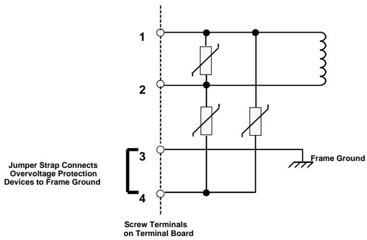
图4-12. 过电压保护装置及跨接线
