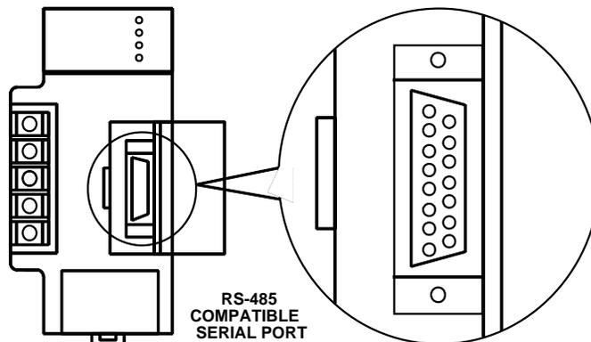
图 5-3 电源模板上的 CPU 串口连接器
