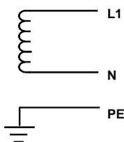
此系统必须遵循下页的特殊安装指示进行安装。系统电源分配线的一路分支连接到保护地或从电源分配线两分支之间分接到保护地，这不是中性点浮动系统。
