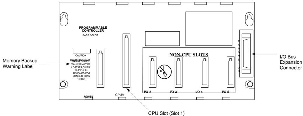
图 5-2 IC693CHS397 5 槽可插入式 CPU 基板
