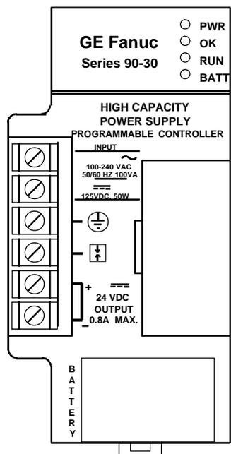
图 1-2 供电电源模板
