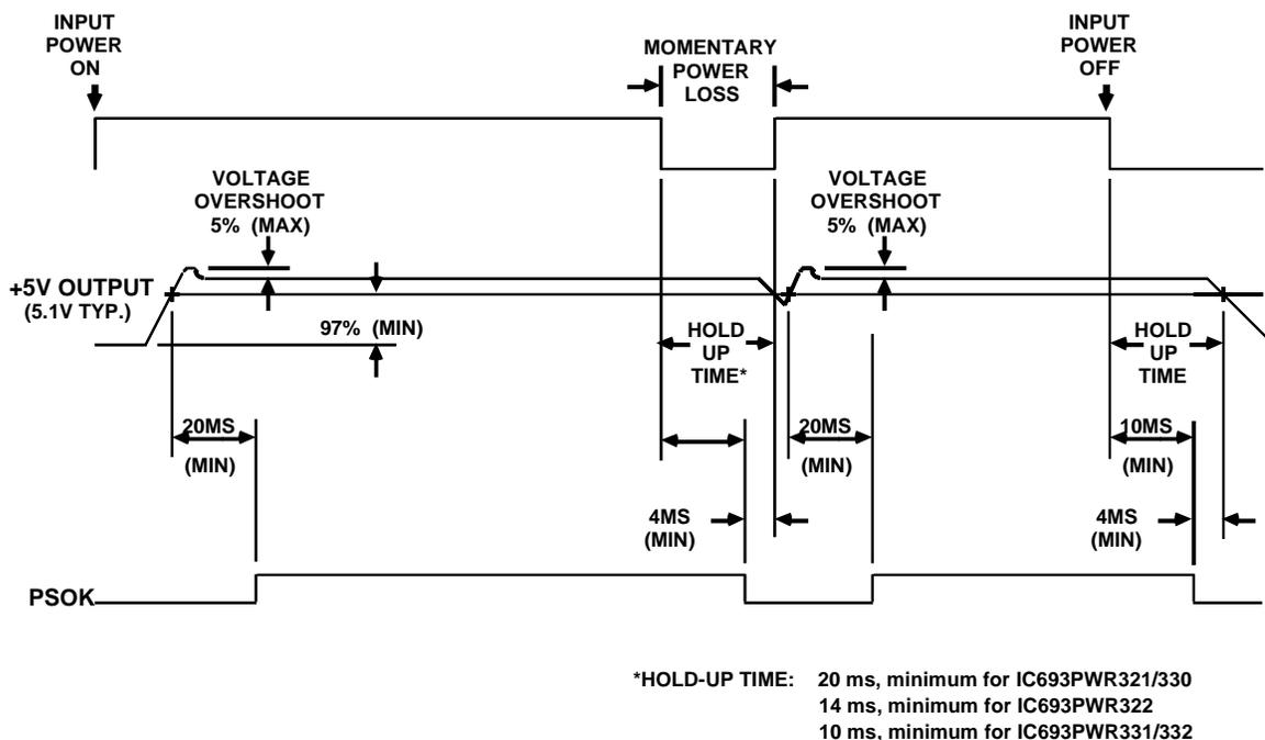
图 4-14. 所有系列 90-30 电源的时序图
