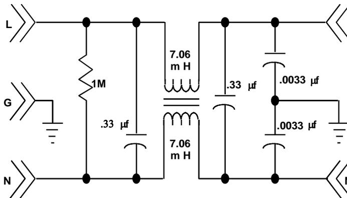
图 L-2. 等同回路 44A720084-001 线性过滤器
