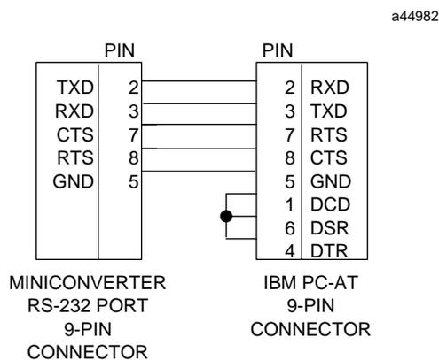
图 D-2 对 PC-AT 的小型转换器
