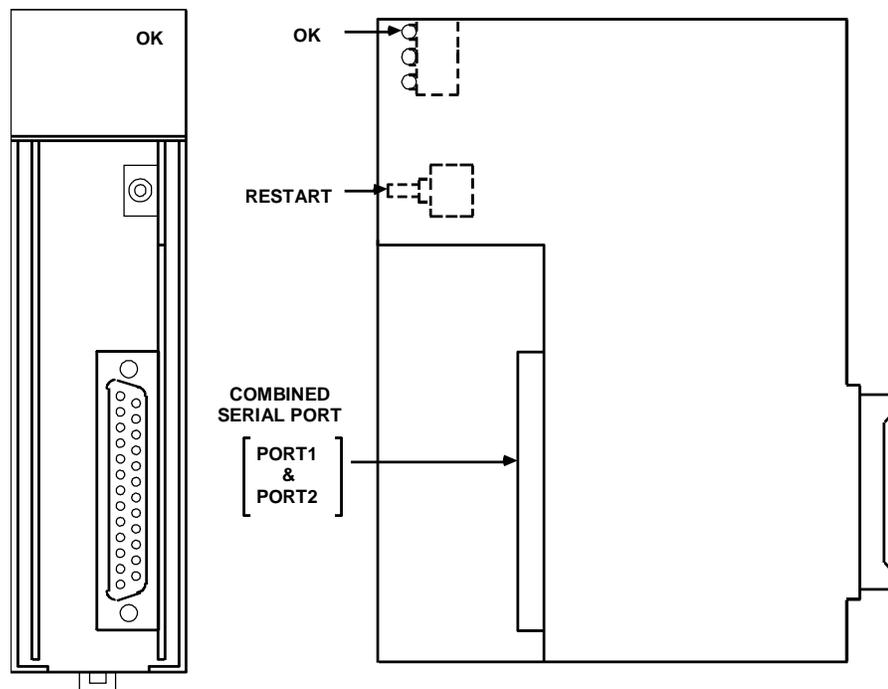
图 9-1. AD693CMM301 状态逻辑串行通讯模板
