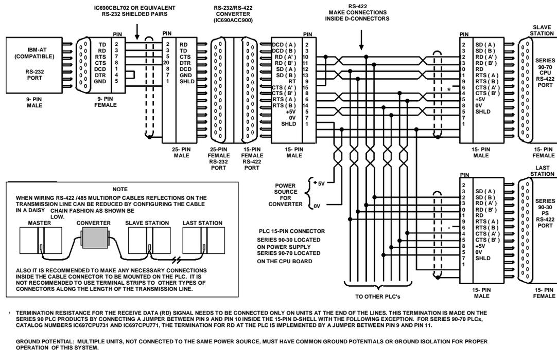
图 A-9 IBM-AT/系列 90 PLC 的多点连接
