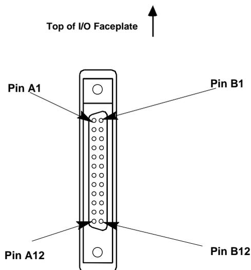
图10-34。关于 I/O 面板连接器的导向
