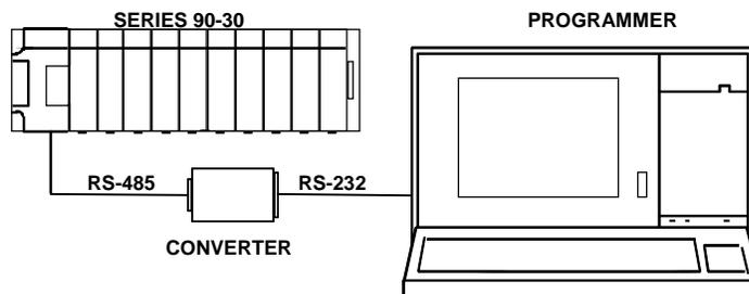
图 11-3 IC690ACC900 转换器的连接示例
