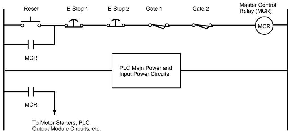
图 12-1. 硬线 MCR 回路示例
