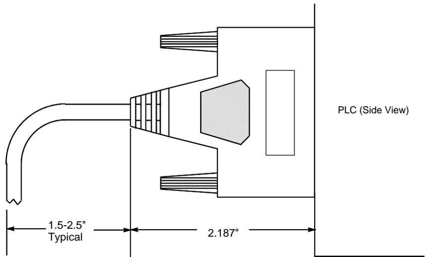
图 10-33。 PLC 前面连接器的深度尺寸
