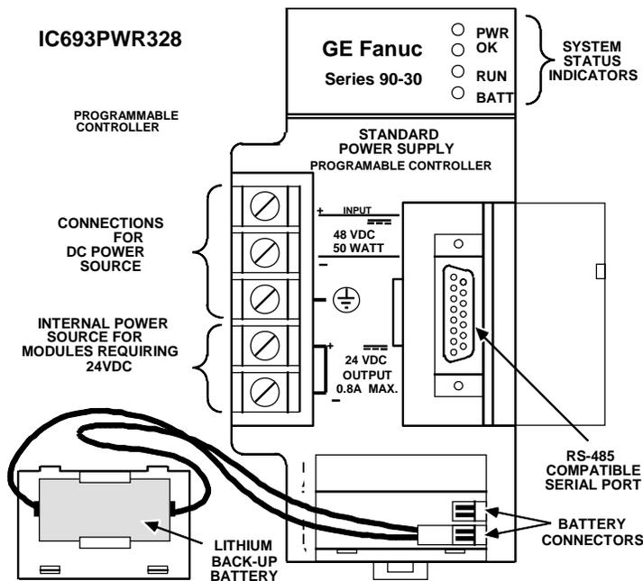
图 4-6. 系列 90-30 48 VDC 输入电源 - IC693PWR328
