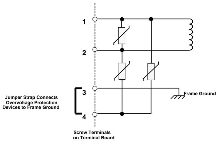
图 4-3. 过压保护装置和跳接线
