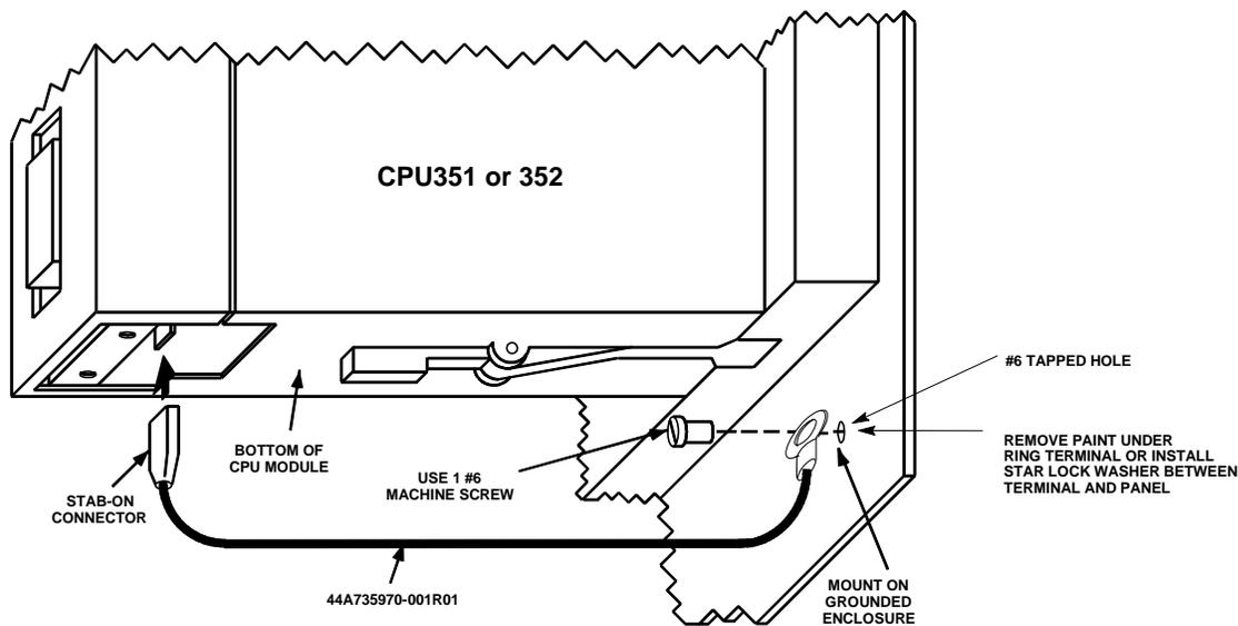
图 2-12 CPU 351 或 352 – 附带的屏蔽接地线
