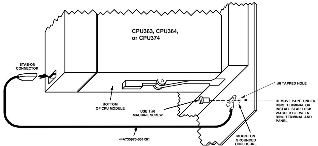
图 2-14 CPU 363, CPU364, 或 CPU374 – 附带接地线
