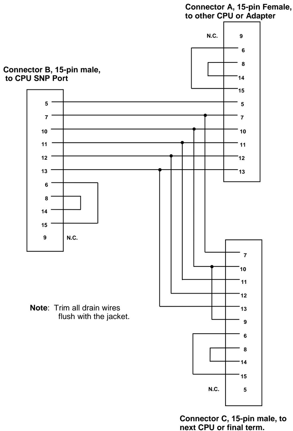
图 10-11 多点连接电缆 IC690CBL714A 的接线图
