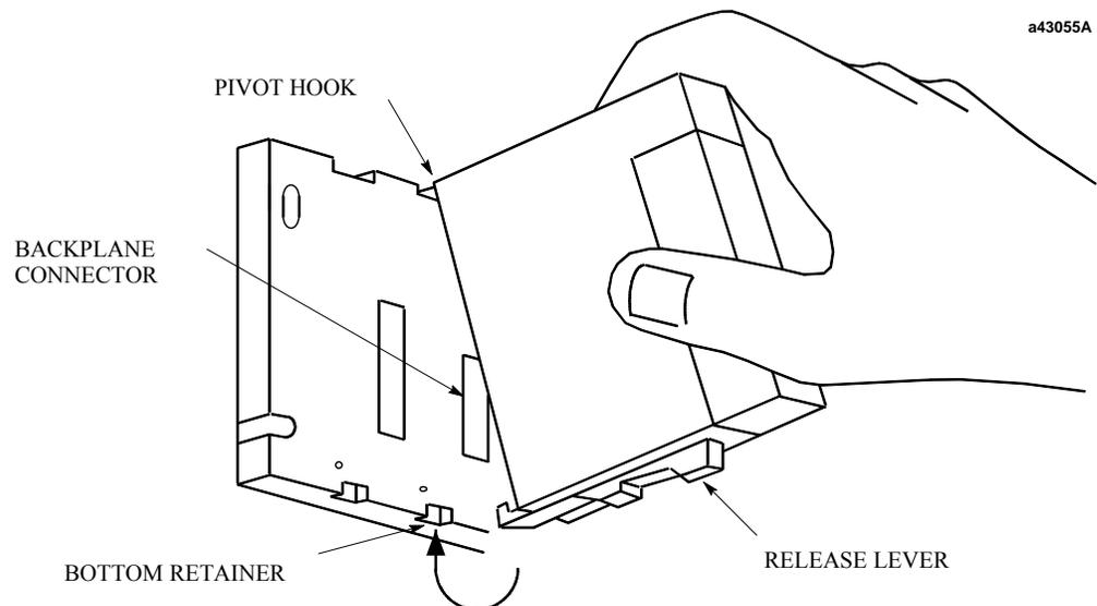
图 2-2. 模板的安装
