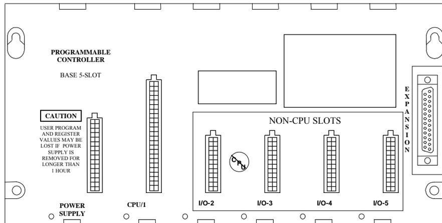
图3-4. IC693CHS397 5-槽模块式 CPU 基析板
