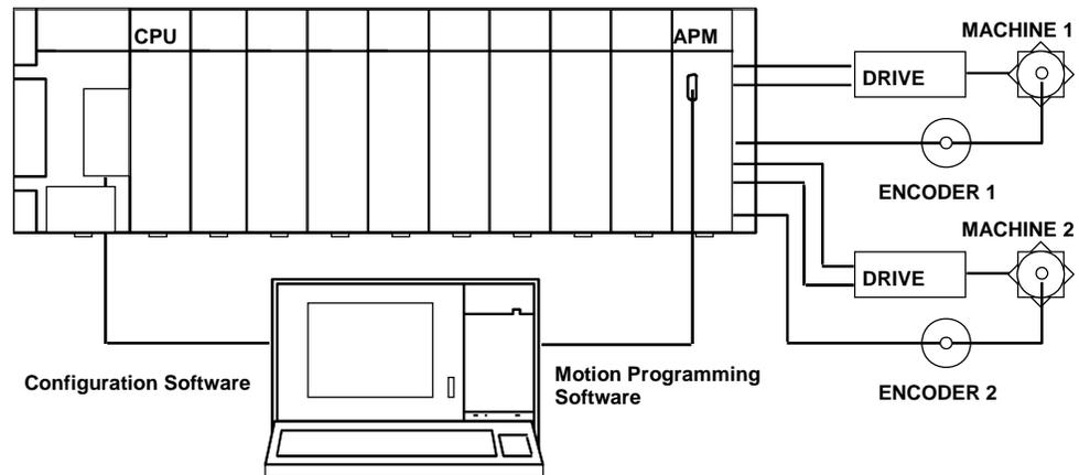
图 8-11. 运动旋转 APM 伺服系统示例
