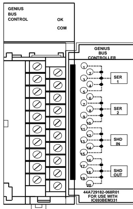
图 8-5. Genius 总线控制模板
