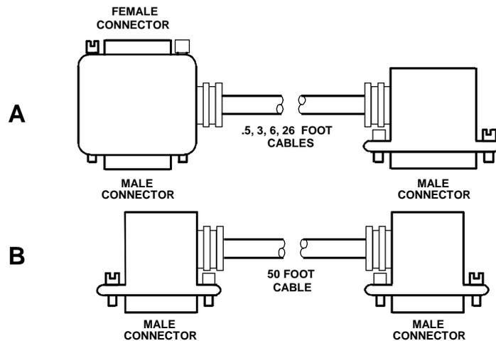
图 10-15 I/O 总线扩展电缆的详图
