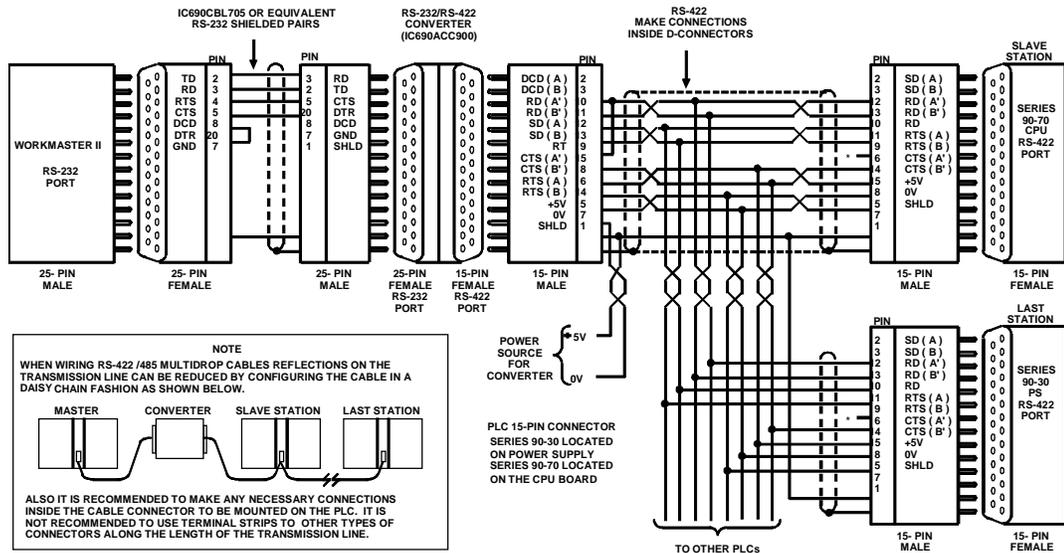
图 10-3 带转换器的多点配置实例
