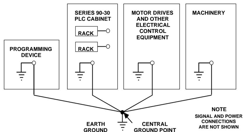
图 2-10. 推荐使用的系统接地
