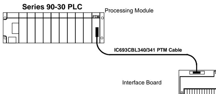
图10-43。 PTM 安装槽架及电缆连接
