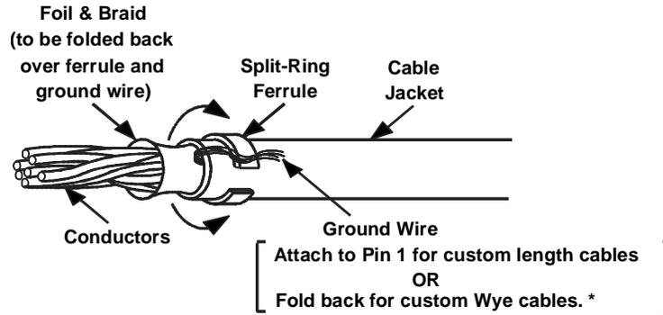
图 10-16 如何使用开口的金属环使电缆起到隔离和防护作用
