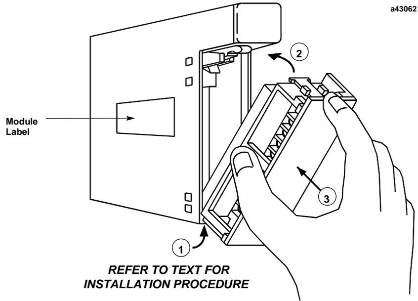
图 2-4. 安装 I/O 模板端子板
