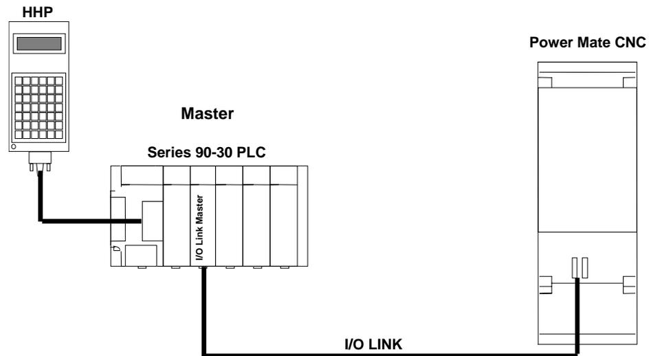
图 8-16. I/O LINK 主站系统配置示例
