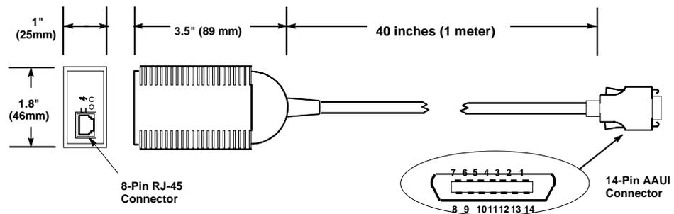
图 J-1. IC649AEA102 以太网 10BASE-T 收发器
