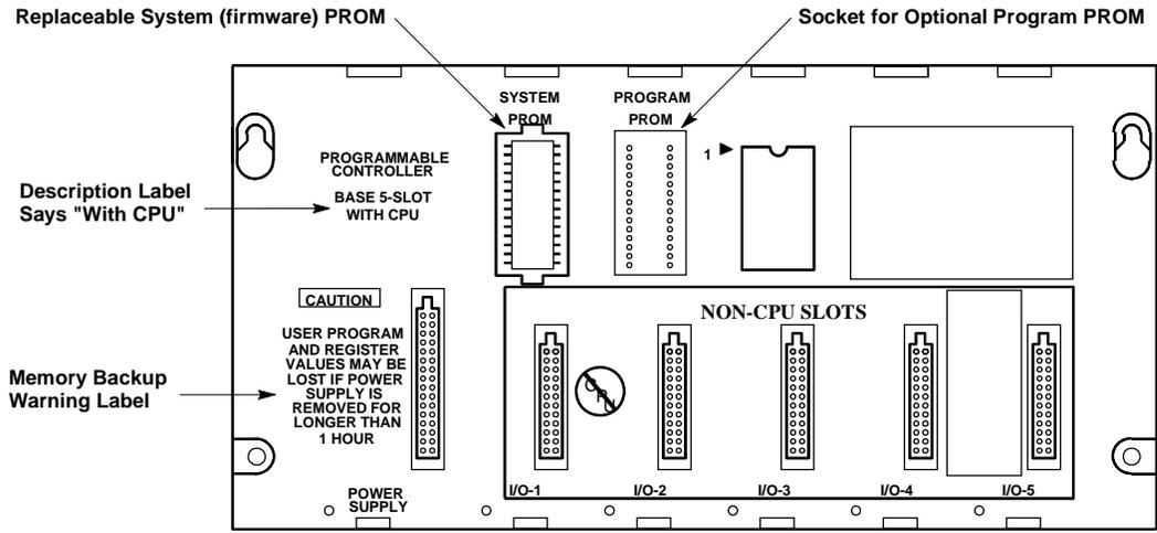
图 3-2. IC693CPU311 和 IC693CPU313 (5-槽) 嵌入式 CPU 基板
