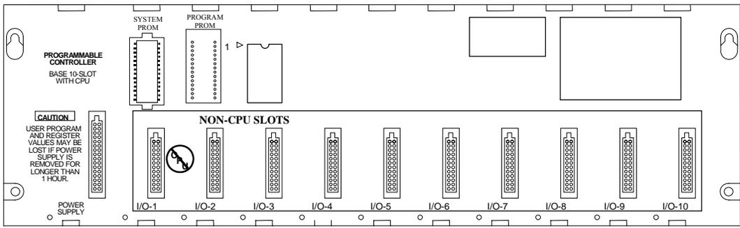
图 3-3. IC693CPU323 (10-槽) 嵌入式 CPU 基板
