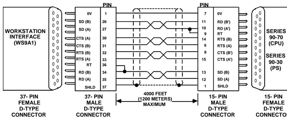
图 10-2 系列 90 PLC 至 Workmaster II 的串行电缆
