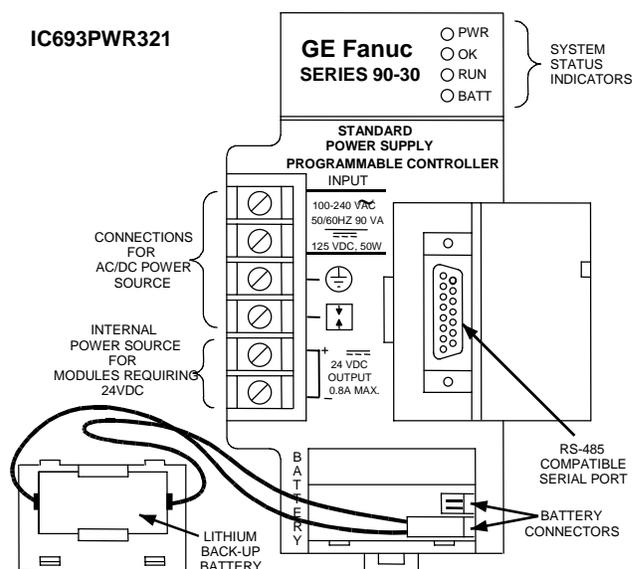
图 4-1. 标准 AC/DC 输入电源 - IC693PWR321
