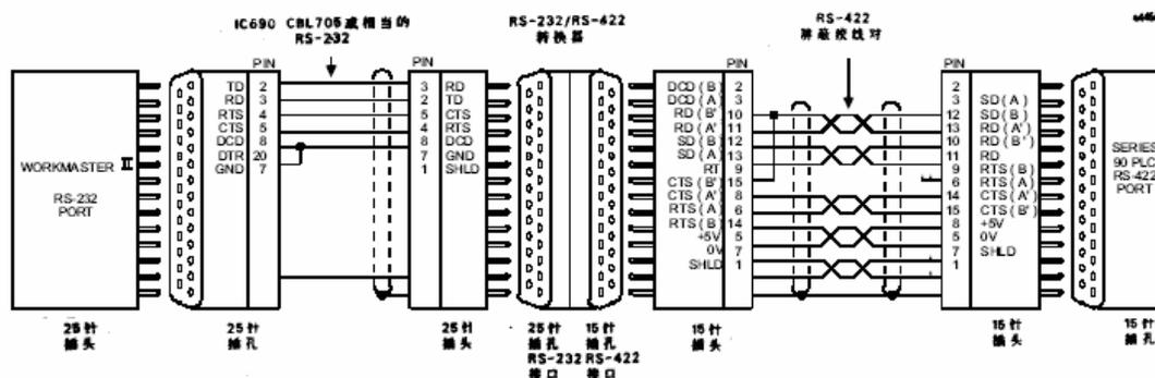
\*用于点对点连接的电源电缆仅为 10 英尺(3 米)，超过 10 英尺的转换器电源和用于多点连接的电源必须是外部电源。
