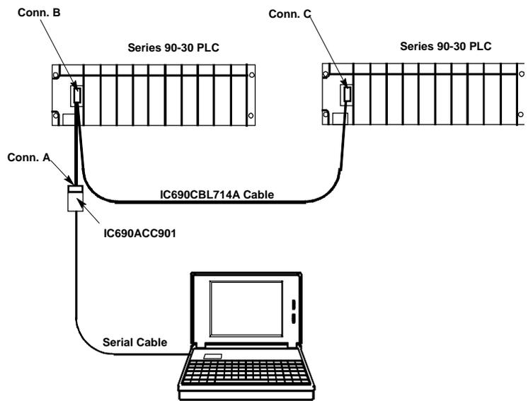
图 10-12 对系列 90-30 冗余系统的多点连接安排
