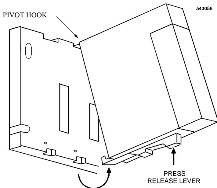
图 2-3. 拆除模板
