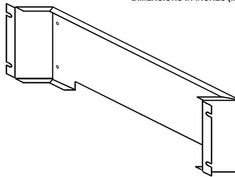
图 2-9. IC693ACC313 凹入式安装适配器支架
