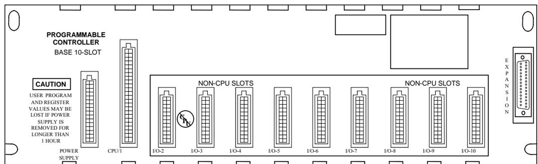
图 3-5. IC693CHS391 10-槽模块式 CPU 基板
