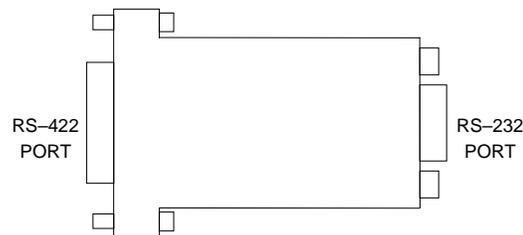
图 11-4 IC690ACC901 系列 90 SNP 到 RS-232 适配器
