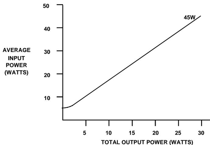
图 4-7. IC693PWR328 电源的典型效率曲线
