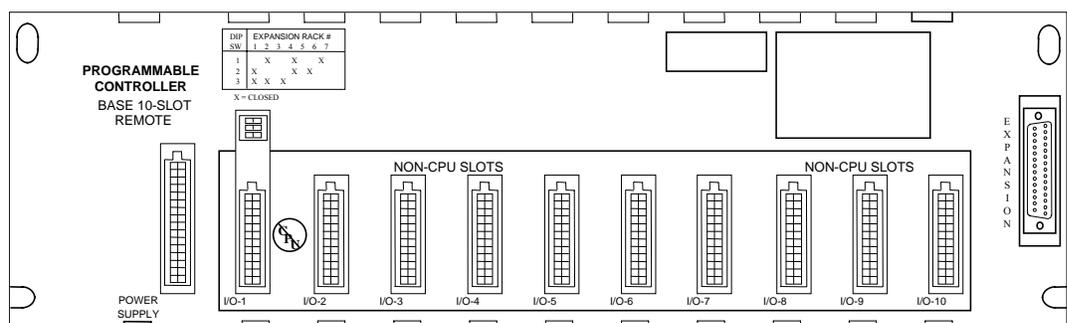
图 3-9. IC693CHS393 10-槽 远程基板
