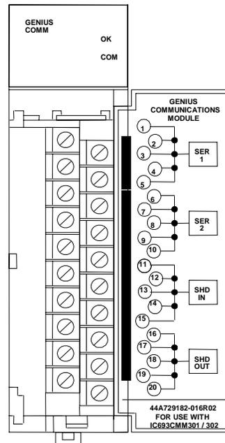
图 8-1. IC693CMM301 GCM 模板
