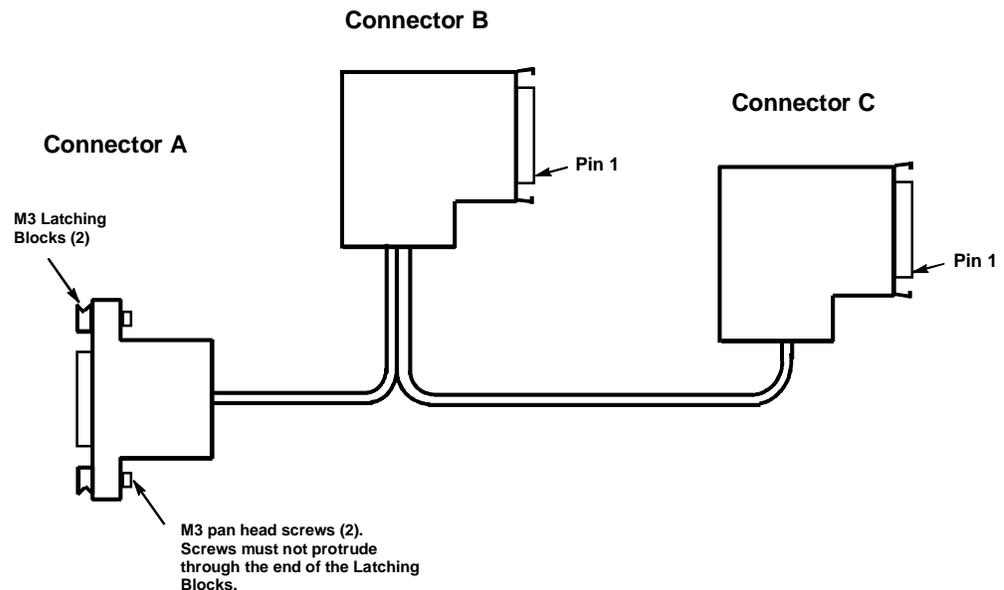
IC690CBL714A 多点连接电缆接线图
