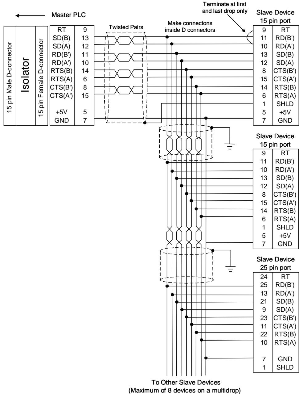
图E-5。采用 15 针串口和 25 针串口进行多点配置中的设备连接
