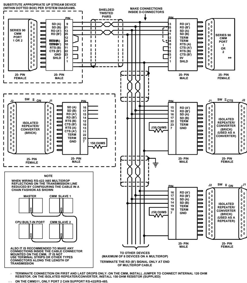
图 C-8 电缆 C;RS422-双绞线
