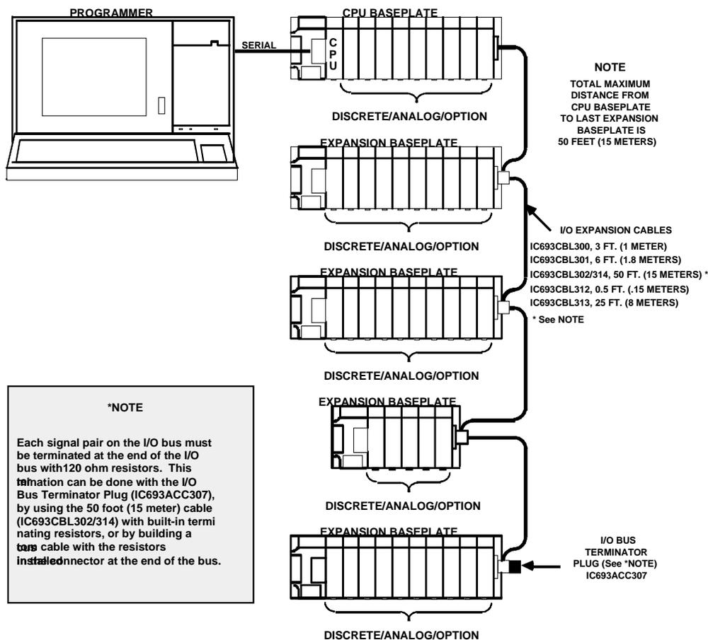
图 10-21 连接远程底座的例子
