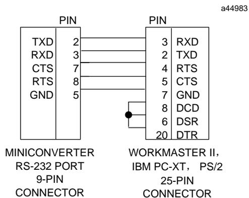
图D-3 对Workmaster II PC-XT, PS/2的小型转换器
