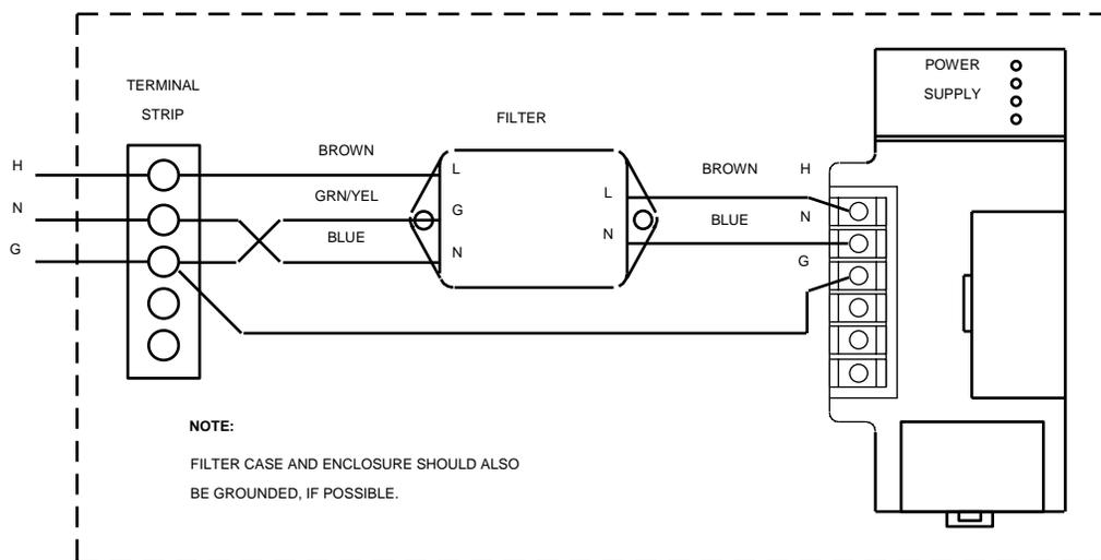
图 L-1. 44A720084-001 线性过滤器连接至系列 90-30 电源
