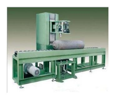
4.采用龙门式和悬臂式组合结构的在线布氏硬度检测系统:
