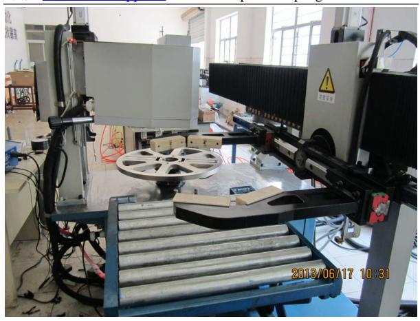
根据客户要求,我们可以为客户量身定做各种测试原理的洛氏/布氏/维氏/里氏硬度计,根据工件形状可以选择自动上下料系统,根据测试原理,可以定制布氏原理硬度计,维氏原理硬度计,里氏在线检测硬度计,针对布氏/维氏硬度计,可以选用前处理设备如自动抛光/自动铣削以获得光洁度达到测试要求的平面,加载方式可以选用砝码加载或者力传感器自动加载方式,读数方式可以选用 CCD 读数系统(布氏测量球压痕压面直径,维氏测量四棱锥压头的菱形压痕对角线长度)或光栅尺测量压入深度(洛氏原理),主机架可以采用龙门式,悬臂式等高刚性结构,工件搬运方式可以采用输送带或者机械手自动夹持搬运等方式,如需工件自动翻转,我们也会为客户量身定做各种机械手。
