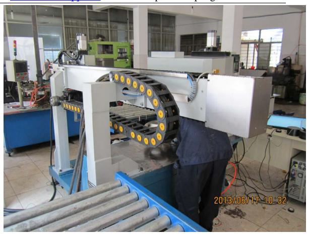
机械手自动送料系统或者<u>自动上下料系统</u>,一般设计到多个位置的自动定位,中途搬运,自动夹持,有时还需要自动翻转,所以都是多轴运动控制系统,我们可以根据客户的要求和产品的特点,定做各种自动搬运机械手,在实践中已经做到九轴运动,具有多个自由度,已经成功应用在大型加工中心,热锻,自动硬度检测等场合。
