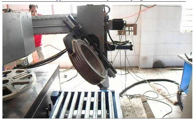
2.采用龙门式结构的布氏硬度自动测量系统:
