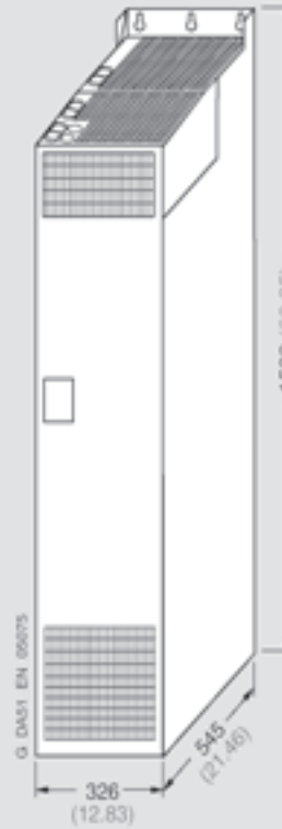
外形尺寸 GX 的变频器
