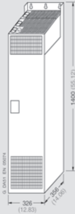
外形尺寸 FX 的变频器
