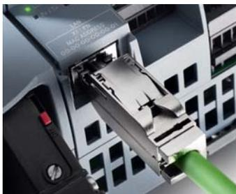
集成的 PROFINET 接口用于编程、HMI 通信和 PLC 间的通信。此外它还通过开放的以太网协议支持与第三方设备的通信。该接口带一个具有自动交叉网线（auto-cross-over）功能的 RJ45 连接器，提供 10/100 Mbit/s 的数据传输速率，支持
