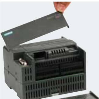
卸掉端子盖板
