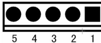
图 3-3 5PIN 单排串行接口插座引脚序号
