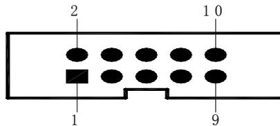
图3-1 IDC10针型 串行接口引脚定义
