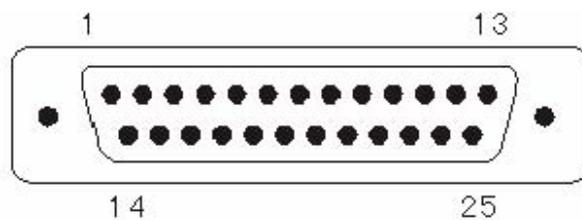
图3-17 DB25针型并行接口插座引脚序号
