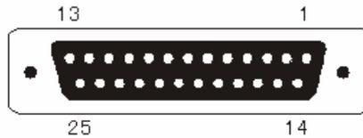
图 3-2 DB25 孔型串行接口插座引脚序号
