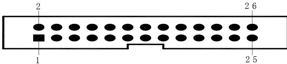
图3-16 IDC26针型并行接口插座引脚序号
