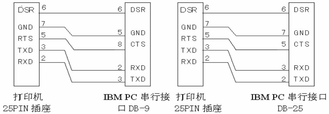
图 3-15 DB25 孔型串行接口与 PC 机串行接口连接示意图
