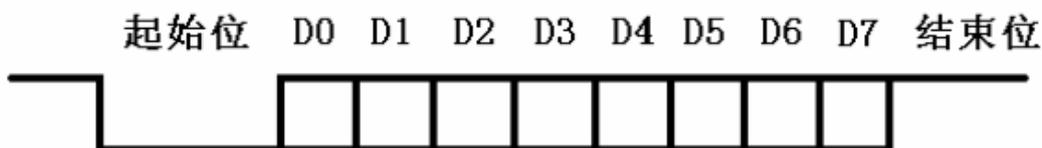
图 7-1 RS232C 串行口数据传输格式图
