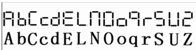
例如：短路清零时，显示  $\overline{\text{CLEAR}} \text{SH}$ ，意义为“CLEAR SH”；
