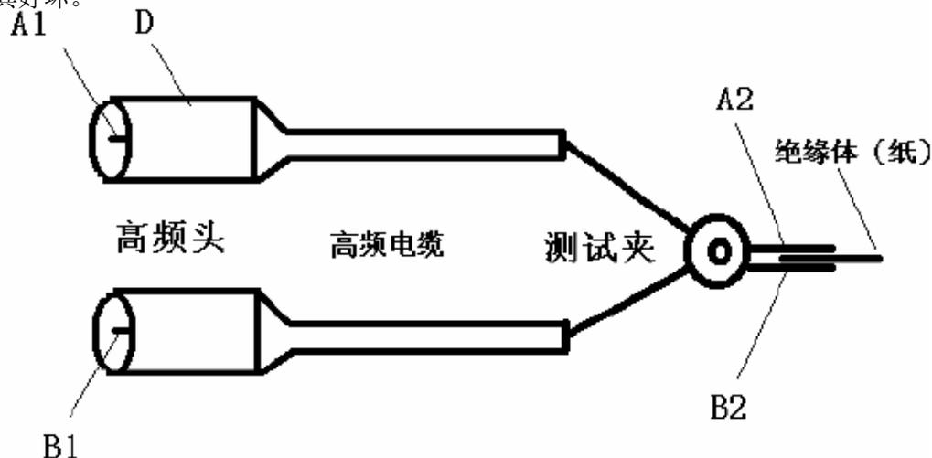
图 9-1 测试电缆局部连线图
