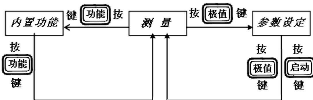
图 4-5 状态转换及按键示意图
