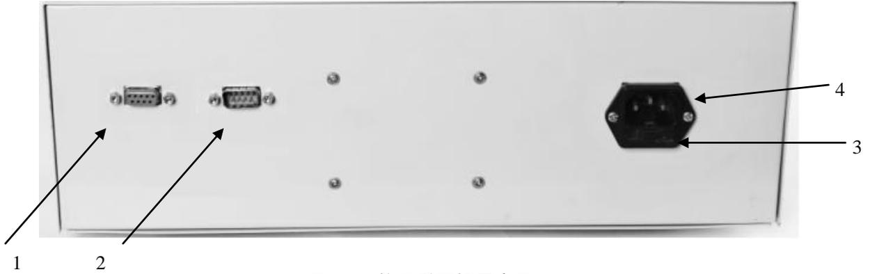
图 4-2 仪器后面板示意图
