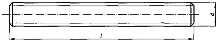
图 3.3.1 全螺纹螺柱
