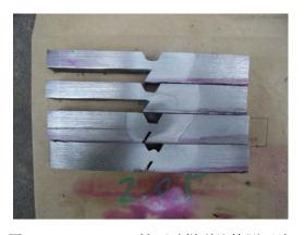
图 5 BHARD400CF-4 铁研试样裂纹检测照片
