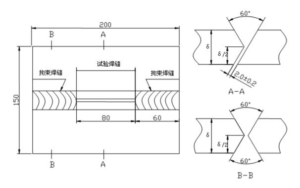
图 1 斜 Y 坡口焊接焊接裂纹试件的形状和尺寸
