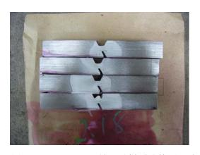
图 3 BHARD400CF - 2 铁研试样裂纹检测照片
