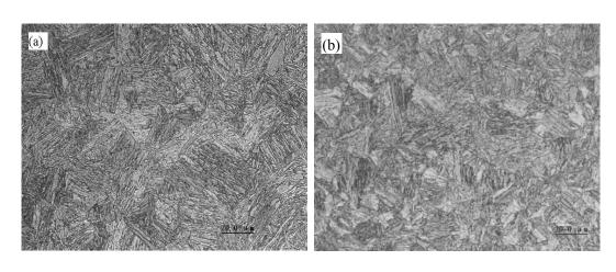
图 4. B-HARD500 显微组织 板材厚度: (a)-20mm; (b)-50mm
