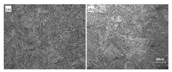
图 1. B-HARD360 显微组织 板材厚度: (a)-20mm; (b)-50mm
