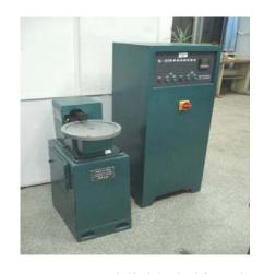
图 1 ML-100 磨粒磨损实验机照片
