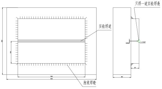
图2 对接接头刚性拘束焊接裂纹实验试样
