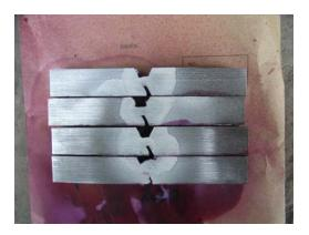
图 2 BHARD400CF-1 铁研试样裂纹检测照片
