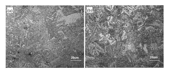
图 2. B-HARD400 显微组织 板材厚度: (a)-20mm; (b)-50mm
