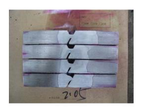
图 4 BHARD400CF-3 铁研试样裂纹检测照片
