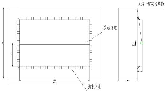
图1 对接接头刚性拘束焊接裂纹实验试样
