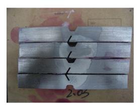
图 6 BHARD400CF-5 铁研试样裂纹检测照片
