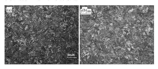
图 3. B-HARD450 显微组织 板材厚度: (a)-20mm; (b)-50mm
