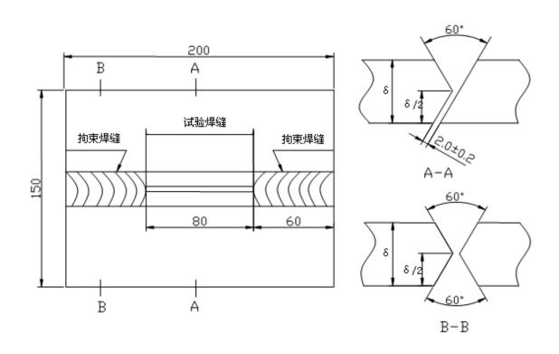
图 1 斜 Y 坡口焊接裂纹试件的形状和尺寸
